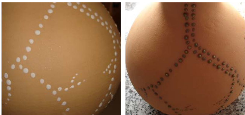
Figura 49 - Jarra cerâmica com aplicação de pontos, antes e após cozedura (da esquerda para a direita).
