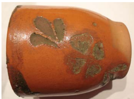
Figura 39 - Cavidade com deposição de resíduo em pó, resultado após cozedura.
