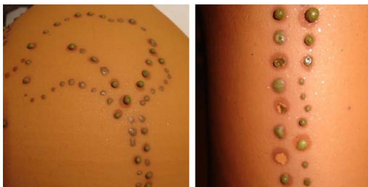
Figura 50 - Jarra cerâmica com aplicação de pontos e com pormenor de uma zona, após remoção manual do bolhado provocado pelo resíduo (da esquerda para a direita).
