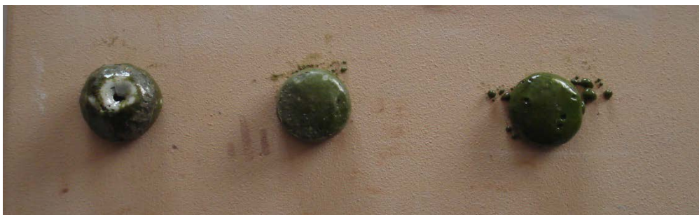
Figura 37 - Amostra de vidro, fase III – 3% de resíduo (FV1+MB1) (FV1+MF) (FV1+MB2).
