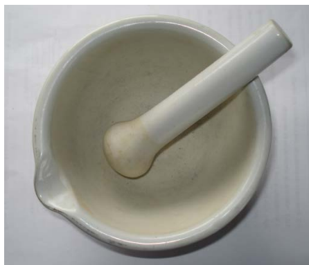
Figura 19 - Almofariz usado na moagem manual dos resíduos. (da esquerda para a direita)
