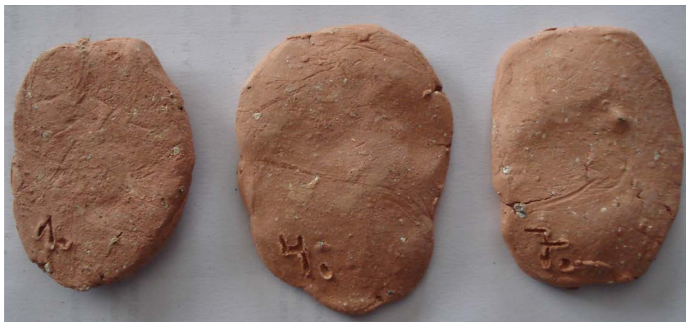
Figura 28 - Amostra referente ao resíduo MB2 com as 3 bases, referente ao Cerâmico II (tabela II).
