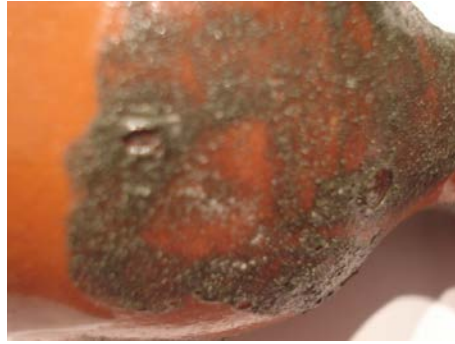
Figura 42 - Aplicação de uma solução 50%-50%, resíduo vs vidrado.
