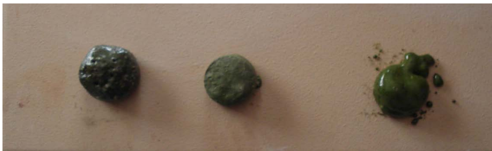
Figura 36 - Amostra de vidro, fase III- 10% resíduo (FV1+MB1) (FV1+MF) (FV1+MB2).
