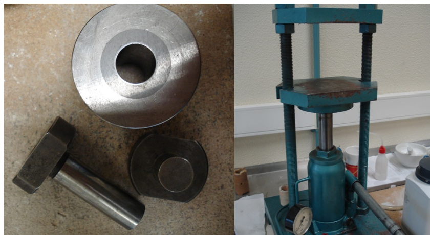
Figura 30 - Da esquerda para a direita: molde metálico para conformação das pastilhas e prensa hidráulica (da esquerda para a direita).
