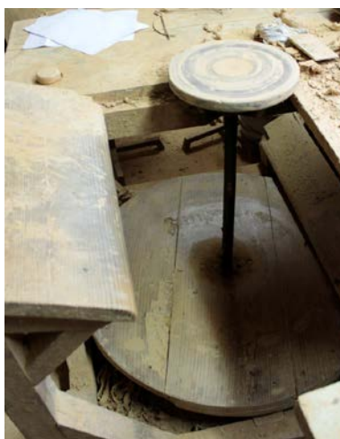
Figura 22 - Roda de oleiro não motorizada
