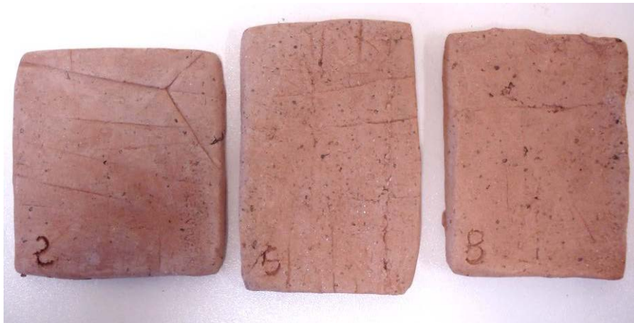
Figura 23 - Amostra referente ao resíduo MB1 com as 3 bases, referentes ao Cerâmico I (tabela I).
