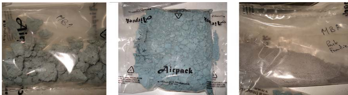
Figura 18 - Resíduos após o processo de secagem, MB1, MF e MB2. (da esquerda para a direita)
