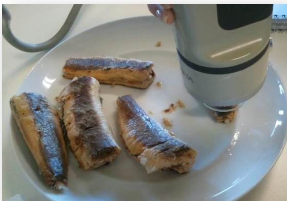
Figura 19: Medição de cor em sardinhas utilizando colorímetro Minolta CR 300.
