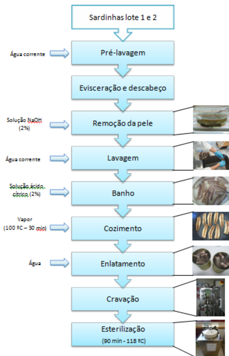
Figura 14: Fluxograma do processo de remoção de pele de sardinhas com NaOH.
