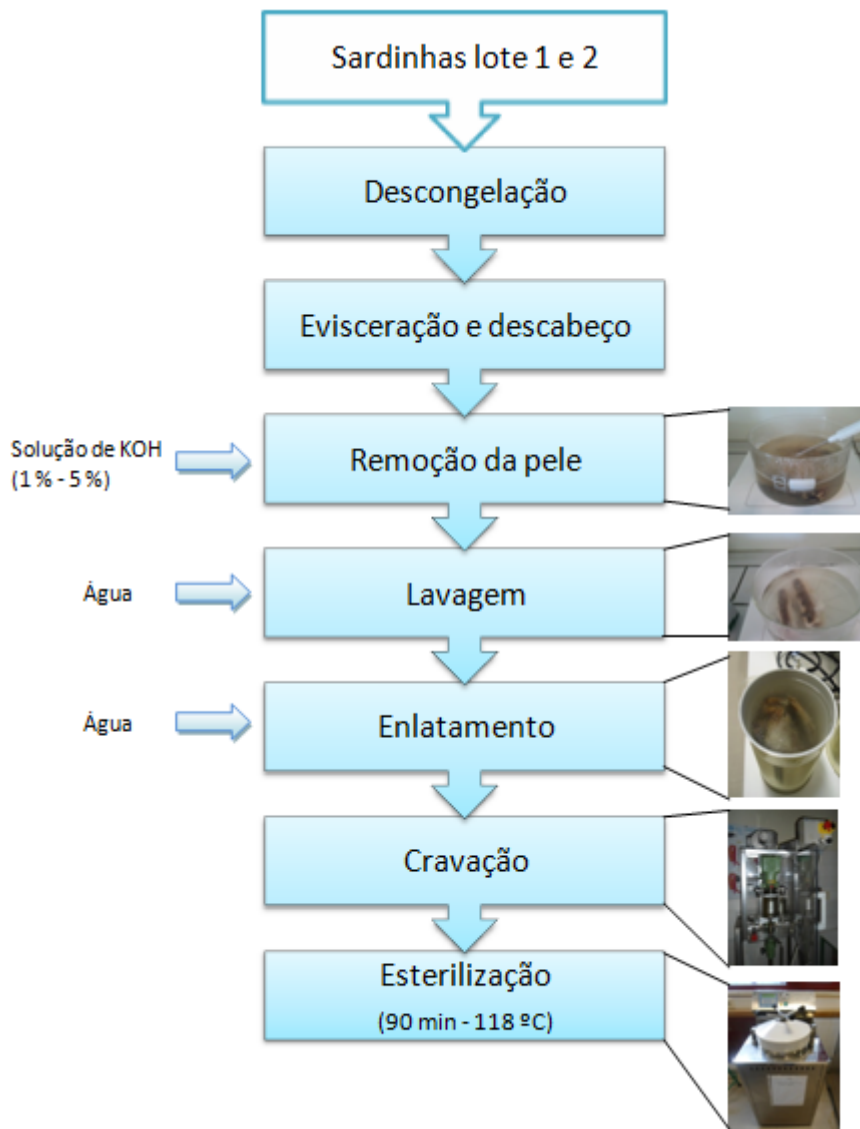
Figura 8: Fluxograma do processo de remoção de pele com KOH.
