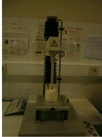
Figura 10 – Texturometro com a sonda cónica P/60c.
