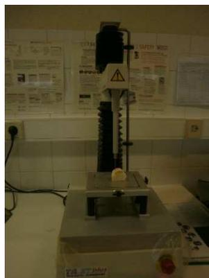
Figura 13 – Texturómetro com a sonda de agulha P/2N.
