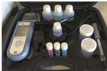
Figura 15 – Potenciómetro.
