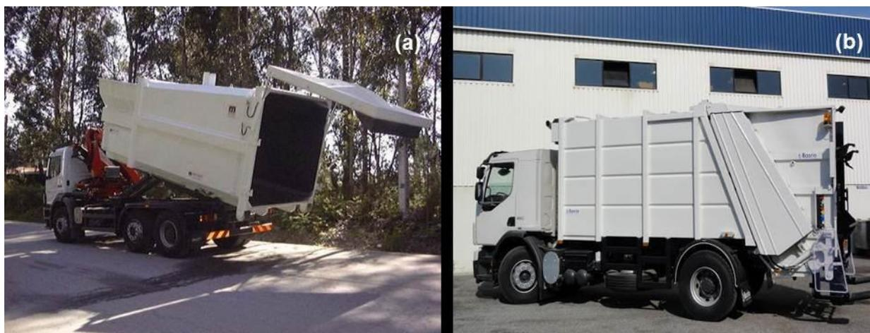
Figura 2.8 – Viaturas utilizadas na recolha de resíduos: (a) viatura ampliroll; (b) viatura de recolha traseira
