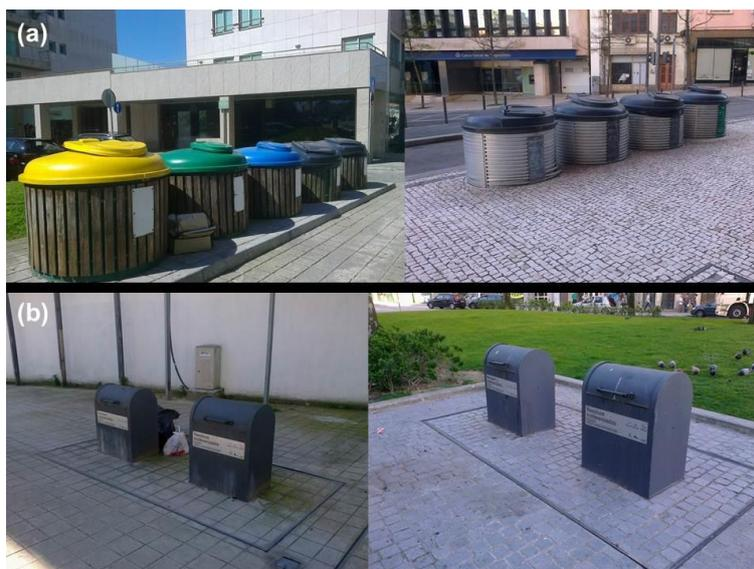
Figura 2.7– Contentores: (a) semienterrados e (b) enterrados
