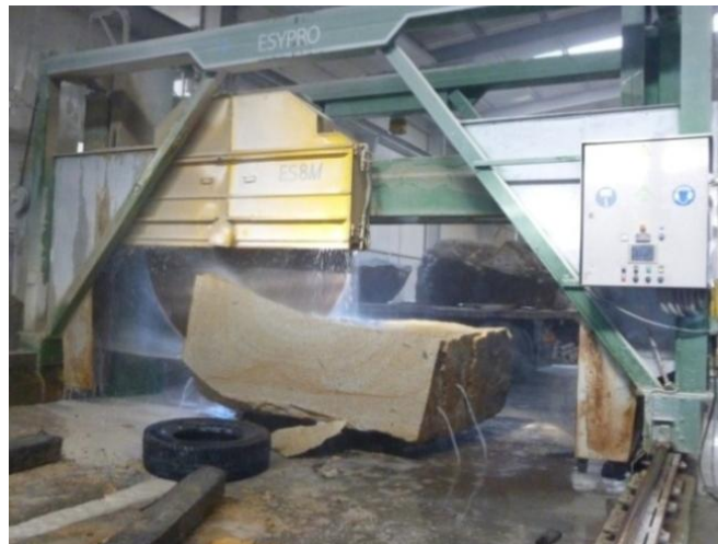
Figura 5.19 – Operações de corte de pedra natural com recurso a água.
