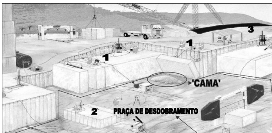
Figura 2.2 – Fases de exploração de uma pedreira de rocha ornamental (1: Corte primário para desdobramento de fatias maiores; 2:esquartejamento em corte secundário; 3: vias de transporte de blocos) (Oliveira, 2006).
