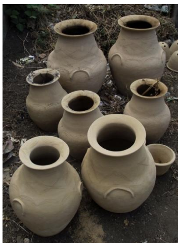
Figura 31 - Peças expostas ao sol com palha a arder no interior.
