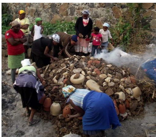
Figura 39 - Início de cobertura do forno.
