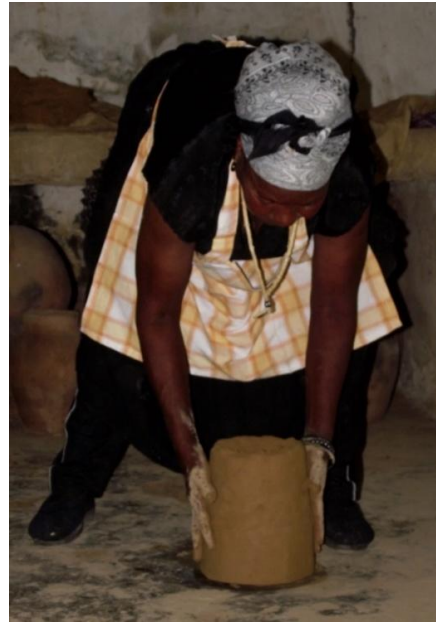
Figura 14 - Colocação da base na posição vertical para se iniciar o levantamento do pote.
