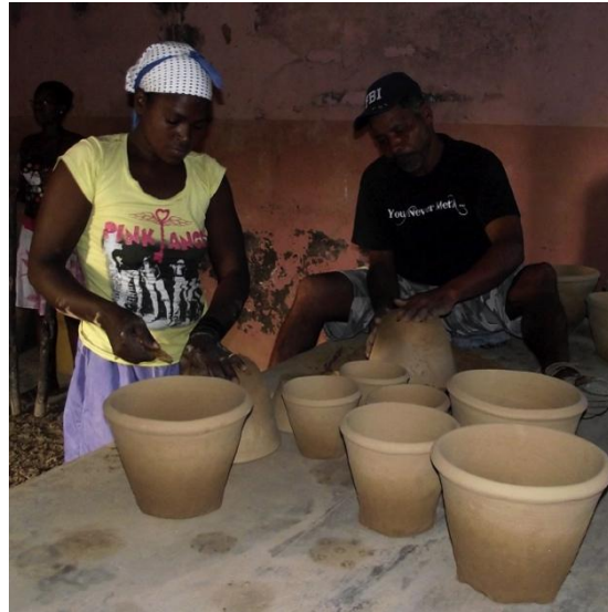
Figura 27 - Alisamento exterior e acabamento com a "inganha" de milho.
