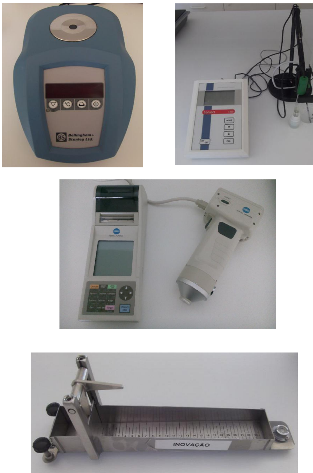
Figura 37 - Equipamentos utilizados para medição dos parâmetros: Refratômetro, Potenciômetro, Colorímetro portátil e viscosímetro de Bostwick.
