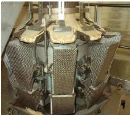
**Figura 34- Sistema de balanças**
