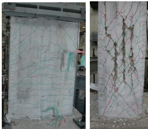
Figura 3.22 Danos no pilar PO2-N3 no final do ensaio
