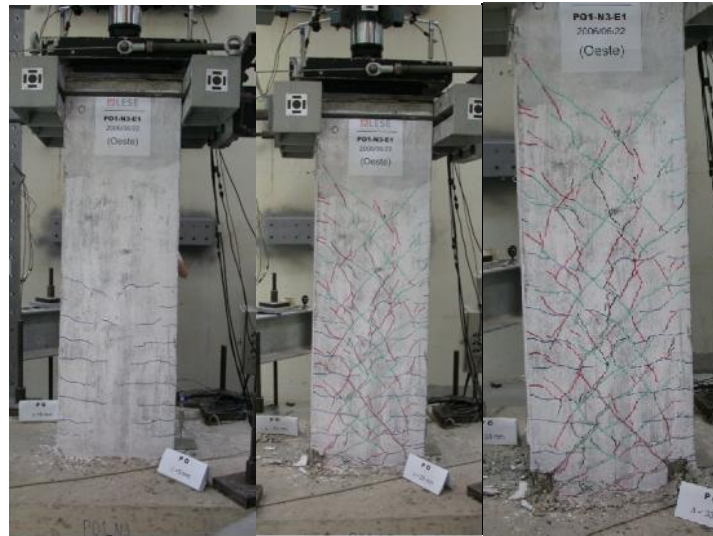
a) Drift 0.36% b) Drift 1.79% c) Drift 2.36% Figura 3.51 Danos nos diferentes valores limite, PO1-N3
