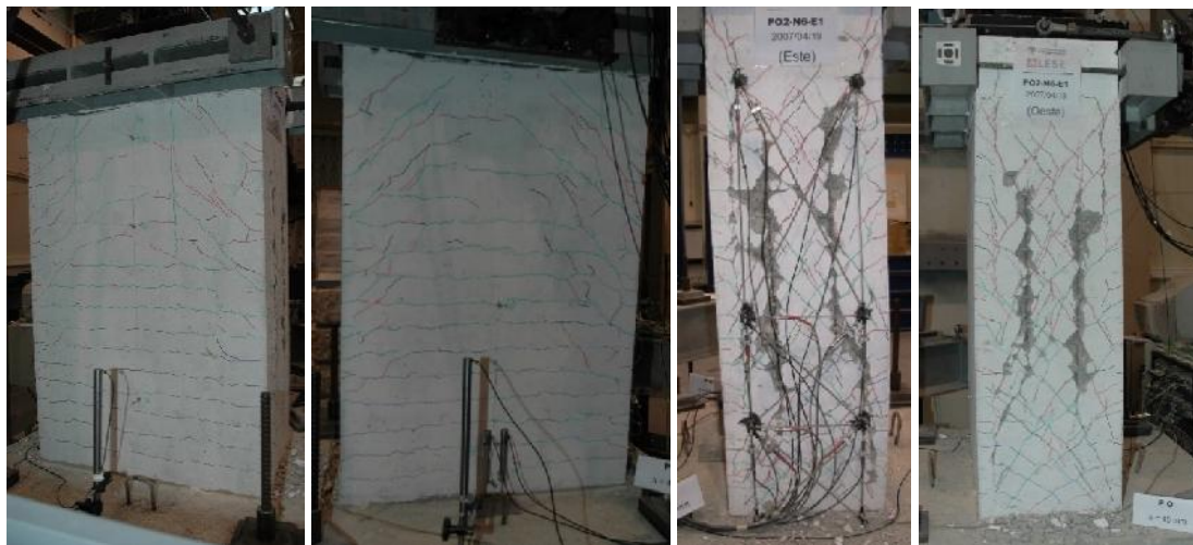
a) Face Norte b) Face Sul c) Face Este d) Face Oeste Figura 3.33 Dano do pilar PO2-N6 no final do ensaio
