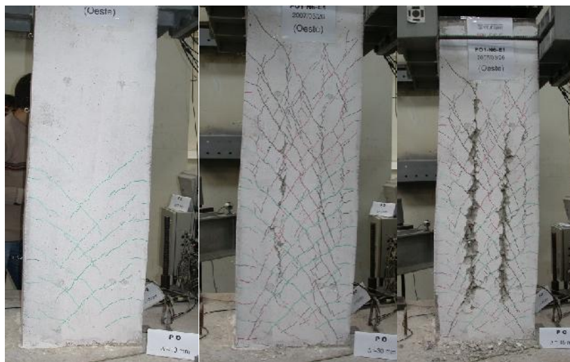
a) Drift 0.71% b) Drift 2.14% c) Drift 3.21% Figura 3.50 Danos nos diferentes valores limite, PO1-N6
