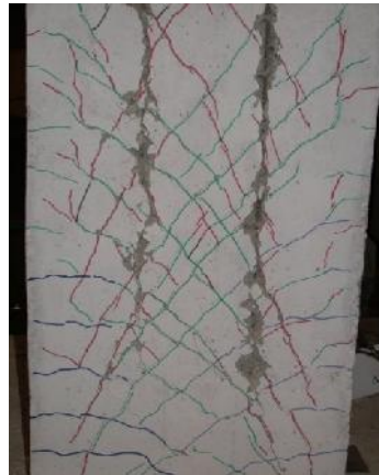
Figura 3.13 Demonstração as duas linhas verticais de destacamento
