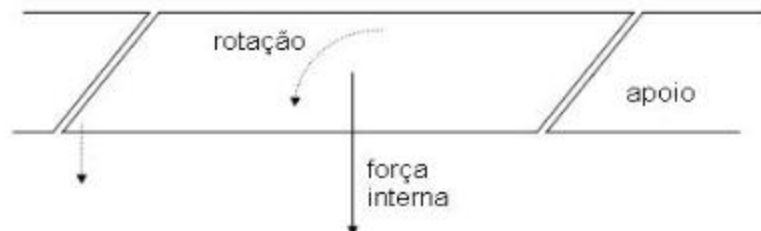
Figura 2.18 Mecanismo de rotação dos tabuleiros sob forças horizontais
