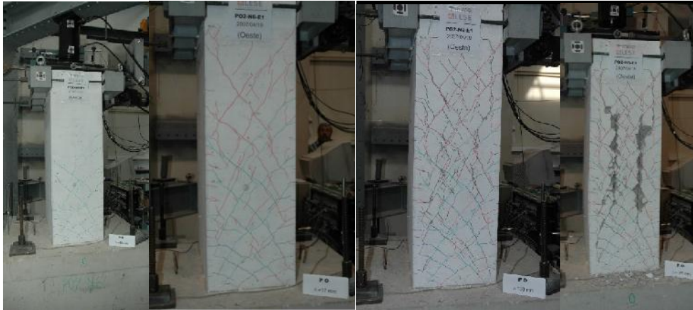
a) drift 0.71% b) drift 1.21% c) drift 2.14% d) drift 3.21% Figura 3.52 Danos nos diferentes valores limite, PO2-N6
