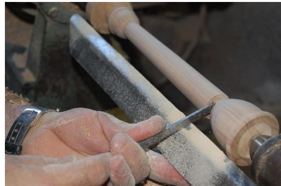
Figura 10- Processo de construção do corpo do instrumento e parte superior, formas e diâmetros praticamente concluídos.
