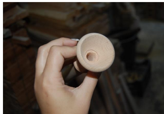
Figura 18- Furação do tubo sonoro realizado da mesma forma que na experiência anterior, desta vez um tubo sonoro cilíndrico e não cónico.
