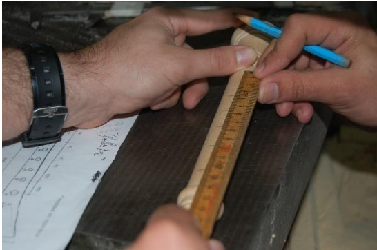
Figura 19- Da esquerda para a direita, Marcação juntamente com artesão das medidas para os furos no corno do instrumento e realização da mesma furacão através da fresa manual.
