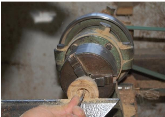
Figura 11- Início da furação da cúpula com o torno a rodar lentamente, depois de um processo lento e minucioso a cúpula está pronta.
