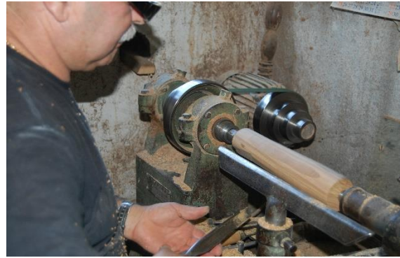
Figura 8- Artesão Manuel Varejão começando o processo de torneamento a fim de atingir o diâmetro pretendido, assim como na imagem seguinte.
