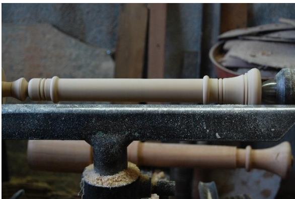
Figura 17- Instrumento já torneado e com a sua forma pretendida em madeira de faia.
