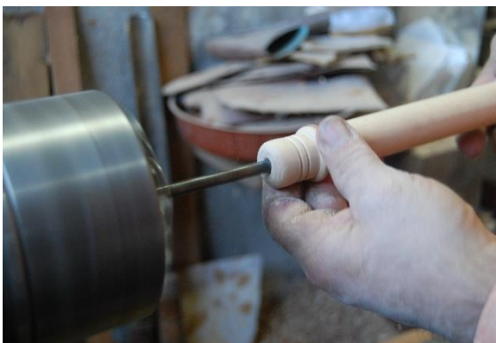
Figura 18- Furação do tubo sonoro realizado da mesma forma que na experiência anterior, desta vez um tubo sonoro cilíndrico e não cónico.
