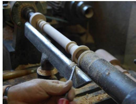
Figura 17- Instrumento já torneado e com a sua forma pretendida em madeira de faia.
