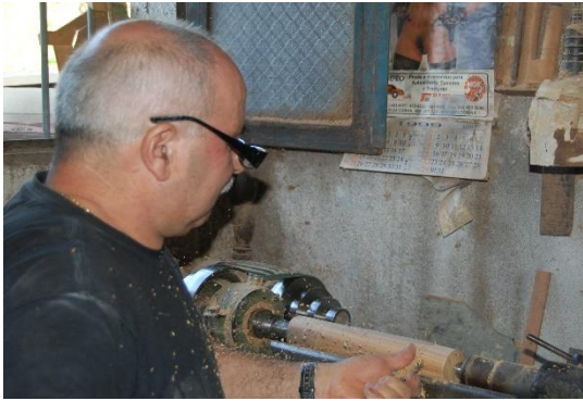
Figura 8- Artesão Manuel Varejão começando o processo de torneamento a fim de atingir o diâmetro pretendido, assim como na imagem seguinte.
