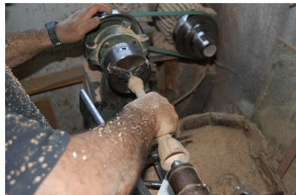
Figura 11- Início da furação da cúpula com o torno a rodar lentamente, depois de um processo lento e minucioso a cúpula está pronta.
