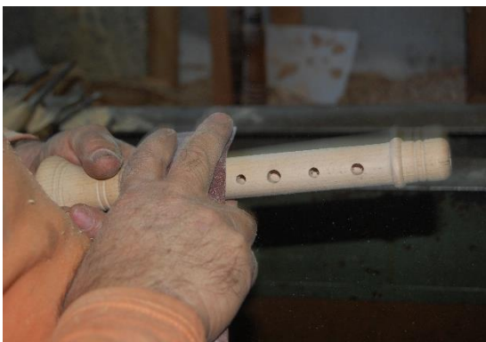
Figura 20- Da esquerda para a Direita, Polimento através de lixa para uniformizar o instrumento, assim como instrumento final.
