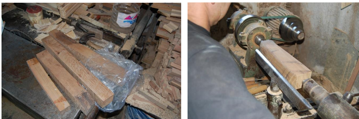
Figura 7- Da esquerda para a direita, blocos de madeira de oliveira prontos a tornear e pedaço de madeira já inserido no torno mecânico
