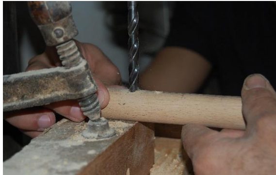
Figura 19- Da esquerda para a direita, Marcação juntamente com artesão das medidas para os furos no corno do instrumento e realização da mesma furacão através da fresa manual.
