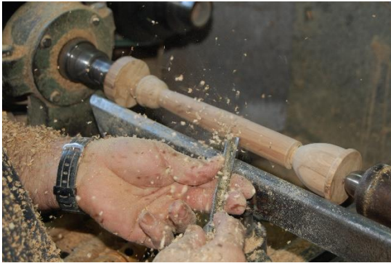
Figura 10- Processo de construção do corpo do instrumento e parte superior, formas e diâmetros praticamente concluídos.
