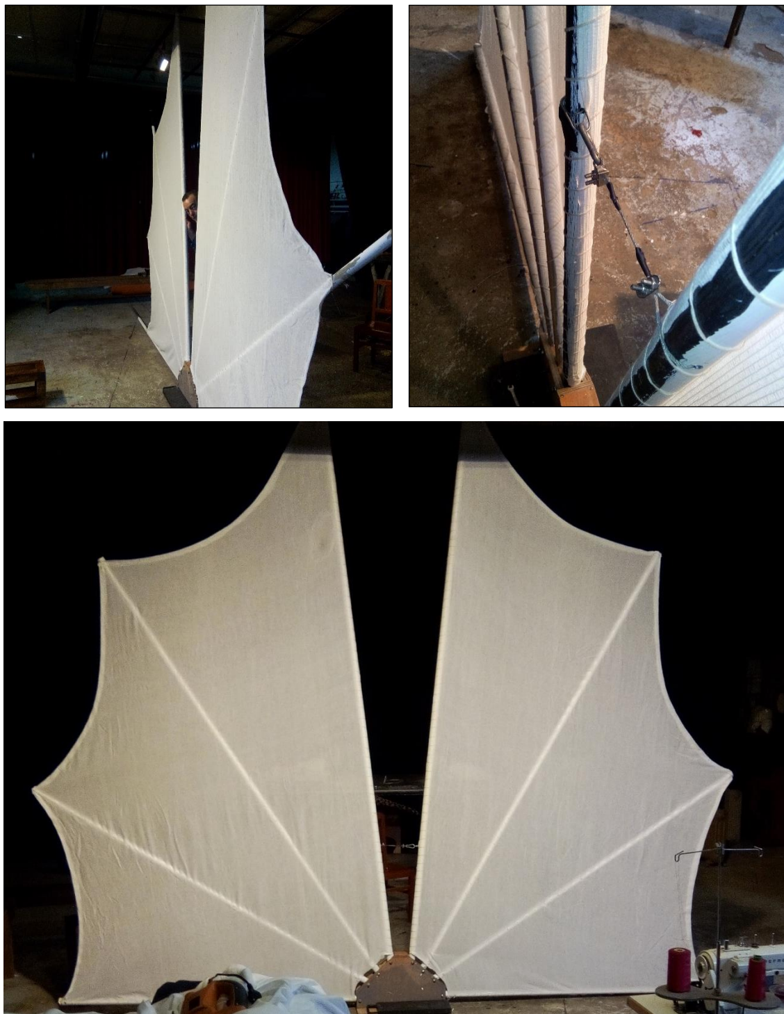
Figura 27: Da esquerda para a direita e de cima para baixo: Marcar o excesso de tubo. Aplicação de um cabo de aço. Asas já acabadas. Foto de Autor: Andreia Lopes
