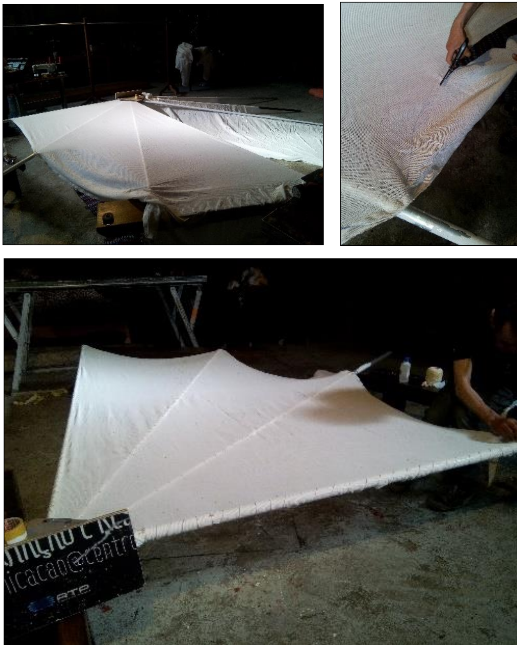
Figura 26: Da esquerda para a direita e de cima para baixo: panos cosidos aos tubos. Corte do excesso de pano. Costura da bainha das asas. Foto de Autor: Andreia Lopes
