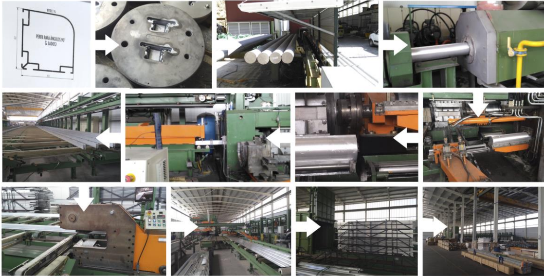
Figura 30: Faseamento cronológico de todo o processo inerente à materialização de um perfil de alumínio. Imagem: Jorge Passos
