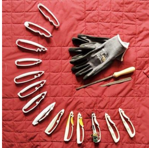
Figura 4: Modelos experimentais da Stylus "Scriba" impressos em 3D relativamente às provas de encaixe ergonômico do produto. Fonte: https://www.autodesk.com/products/fusion-360/blog/scrba-aims-reinvent-stylus-designers/
