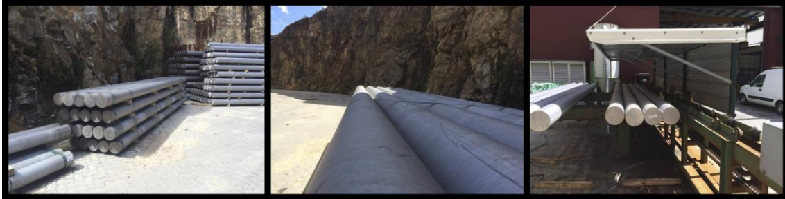
Figura 29: Local de armazenamento das várias ligas de alumínio em bruto (tarugos), onde é feita a escolha do material para o respetivo perfil a extrudir. Imagem: Jorge Passos
