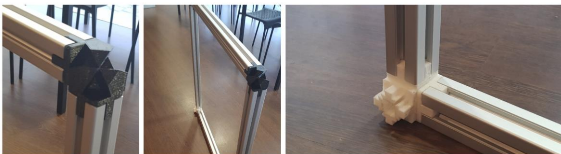
Figura 55: Primeiras verificações do funcionamento do sistema de união com os perfis utilizando uma estrutura básica. Imagem: Jorge Passos
