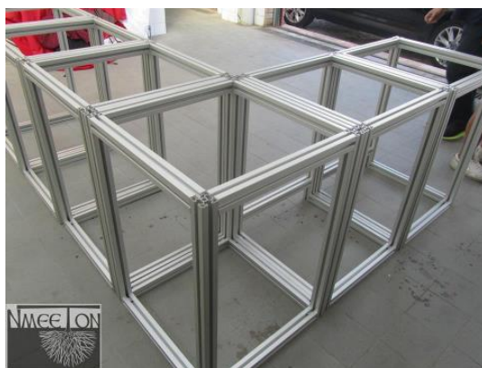
Figura 14: Imagem da estrutura para o módulo desenvolvido para o equipamento da cozinha "NmeeTon" utilizando o perfil Bosch como elemento construtivo. Imagem: Alzira Dias
