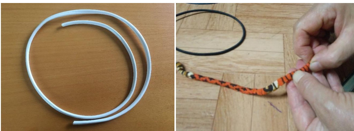
Figura 13 – Da esquerda para a direita: cabo de plástico utilizado no enchimento da experiência 3; introdução do cabo no tecido já costurado. Fonte: Rita FREITAS.
