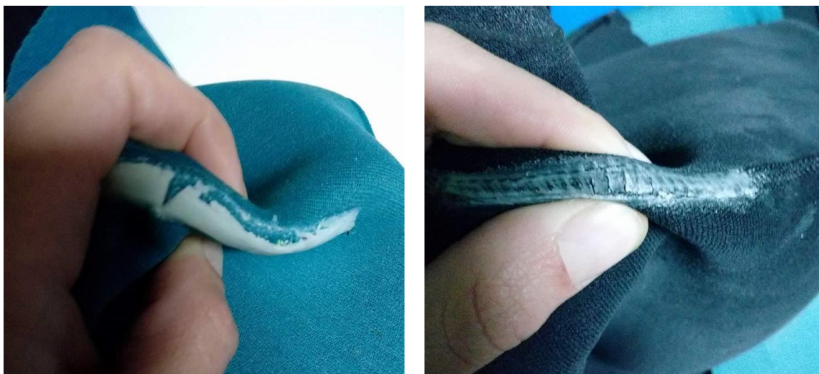
Figura 6-10 Da esquerda para direita: Silicone opaco após secagem; Silicone transparente após secagem. Fonte: Vanessa Duarte
