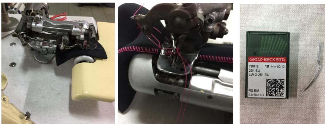
Figura 7-8 Máquina de costura, costura tubular e agulha respetivamente Fonte: Vanessa Duarte
