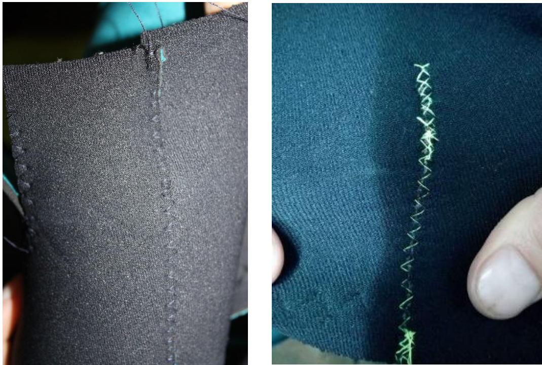
Figura 6-6 Da esquerda para a direita: Costura com linha de poliéster; Costura com linha de nylon. Fonte: Vanessa Duarte
