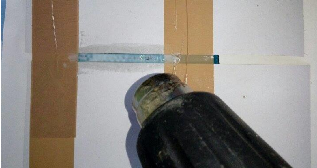
Figura 6-8 Aplicação de calor sobre uma tira de silicone em cima de neopreno. Fonte: Vanessa Duarte
