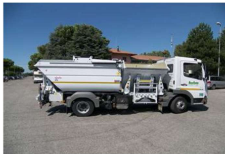
Figura 2-14 - Veículo de recolha misto com e sem compactação
