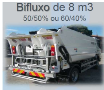
Figura 2-13 - Veículo de recolha bifluxo com compactação
