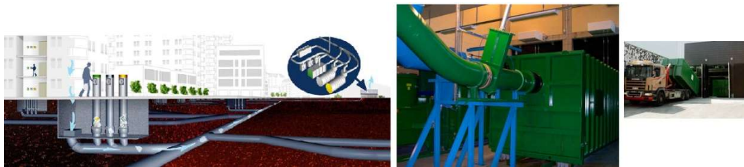
Figura 2-28 - Sistema de recolha fixo (Envac - Automated Waste Collection)
