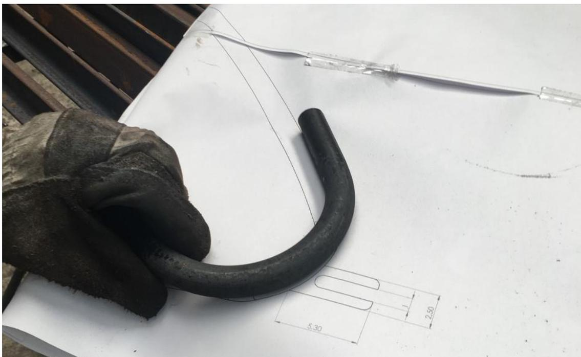
Figura 71 – Moldagem do metal de acordo com o desenho técnico.
