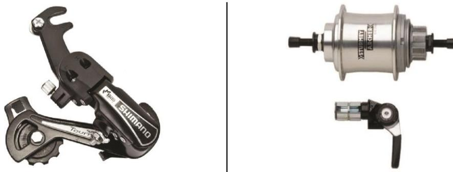
Figuras 36 e 37 - Da esquerda para a direita, desviador *Shimano* (exemplo de mecanismo externo), cubo da roda traseira com mecanismo de velocidades
