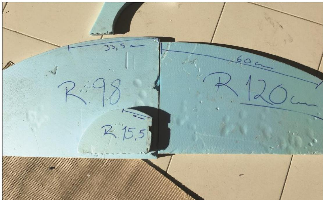
Figura 56 – Moldes dos raios de curvatura
