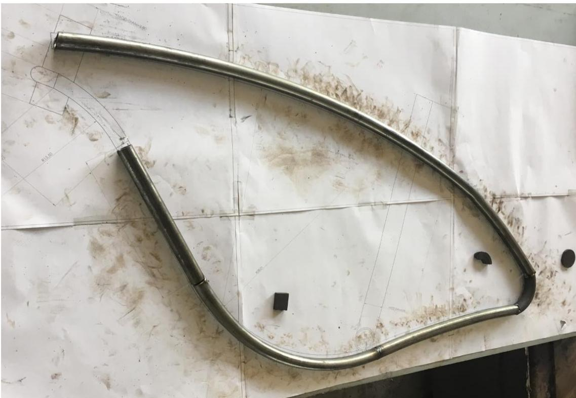
Figura 73 – Verificação das dimensões de acordo com o desenho técnico.
