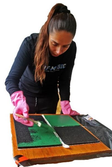
Figura 53 - Aplicação da Resina Acrílica - Polysport
