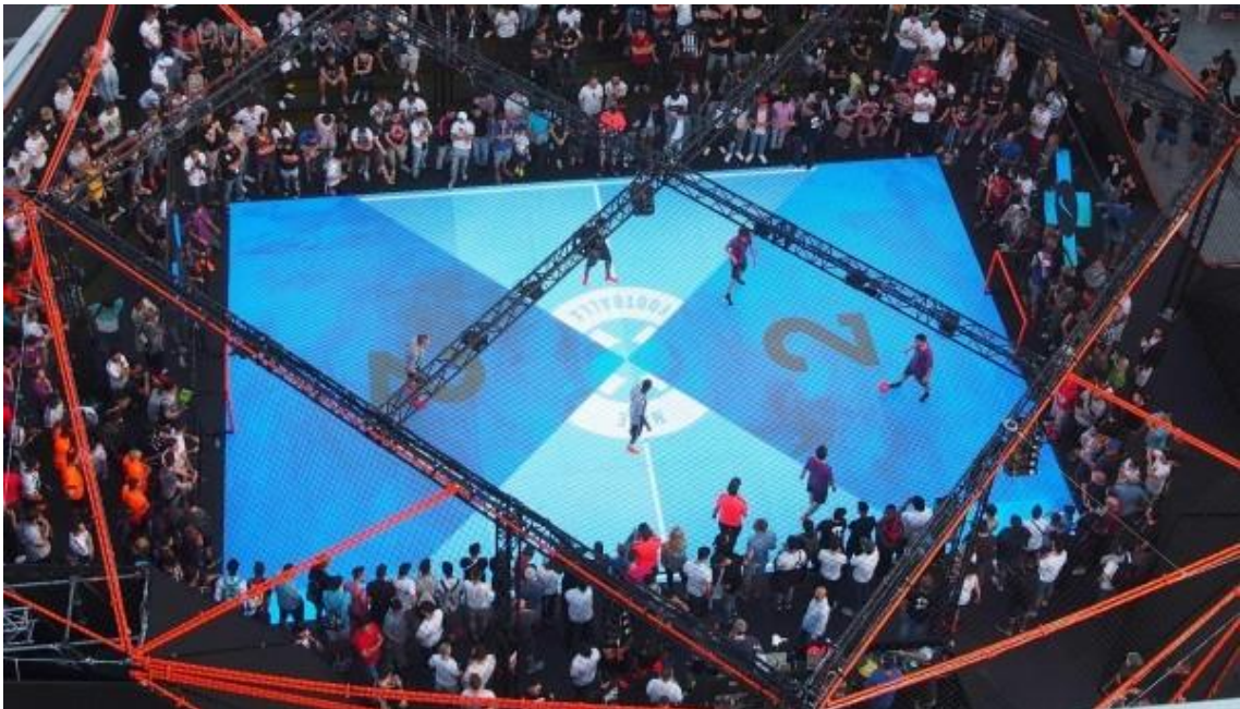
Figura 24 – Campo Interativo – ASB LumiFlex da empresa ASB GlassFloor
