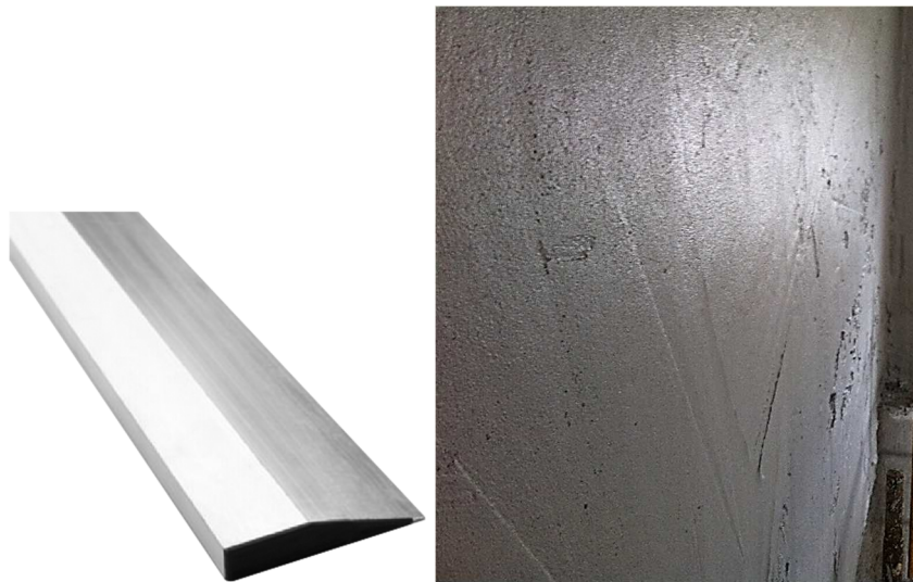
Figura 4.9 - Régua trapezoidal em alumínio para tarefa de "apertar".
