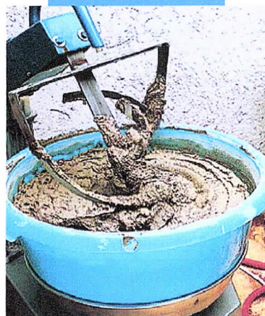
Mistura com mini-betoneira
