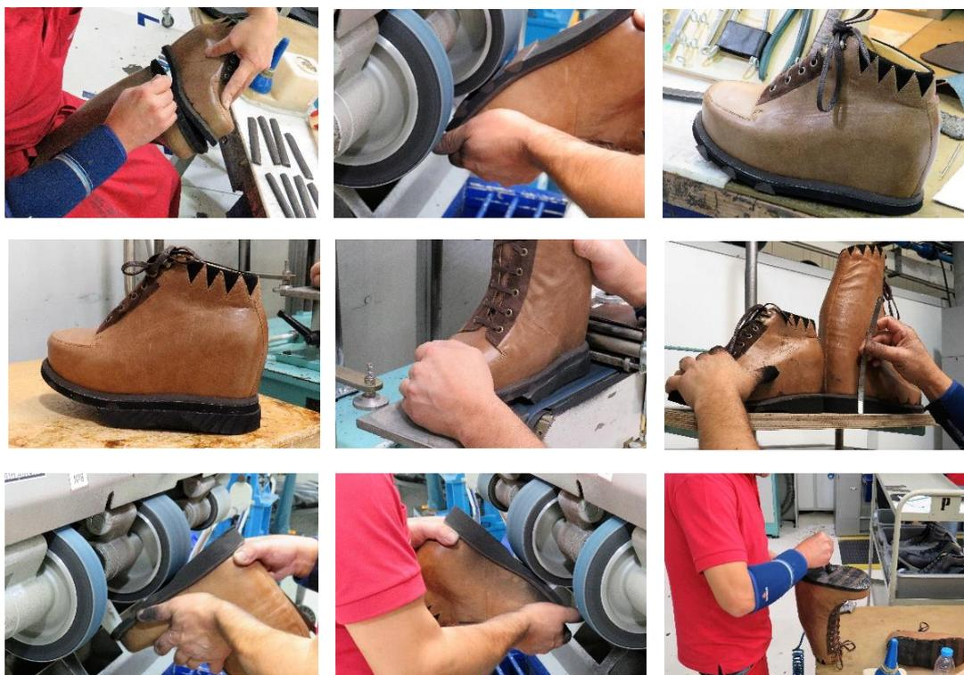
Figura 62- Retificação dos solados e limpeza. (Fonte: Fotografia tirada pela empresa).
