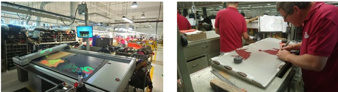
Figura 32-Da esquerda para a direita: corte dos componentes a máquina laser e corte feito manualmente. (Fonte: Fotografia da autora).
