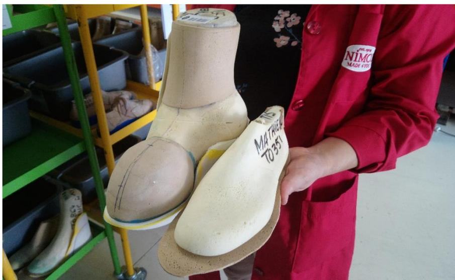
Figura 1-Molde de um cliente da empresa “NIMCO- MADE 4 YOU” com a deformação num dos pés por causa da diabetes. (Fonte: Fotografia da autora).
