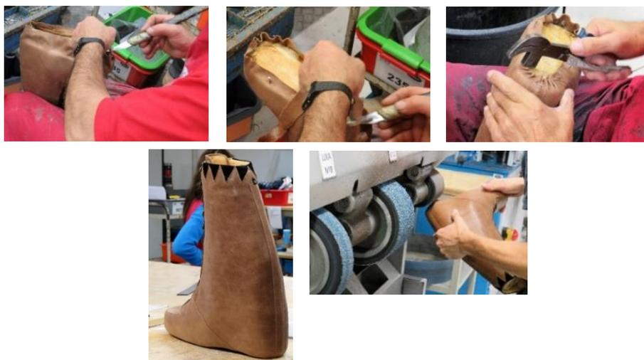
Figura 58- Corte do excesso de material; conformação à palmilha de montagem e polimento das rugosidades. (Fonte: Fotografia tirada pela empresa).
