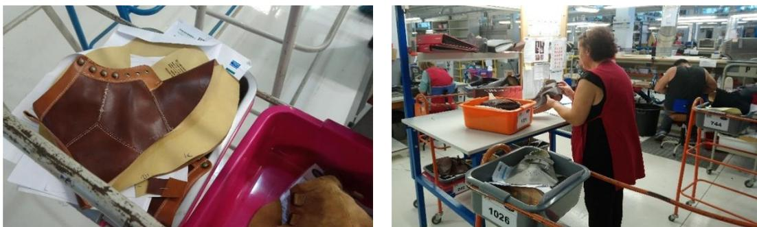
Figura 33- Da direita para a esquerda: os componentes devidamente cosidos, a formar o sapato. O ajuste do corpo do sapato à forma. (Fonte: Fotografia da autora).
