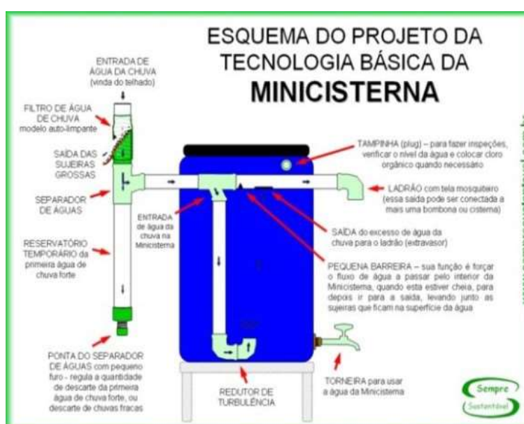
Figura 145-sistema indireto de aproveitamento águas pluviais
