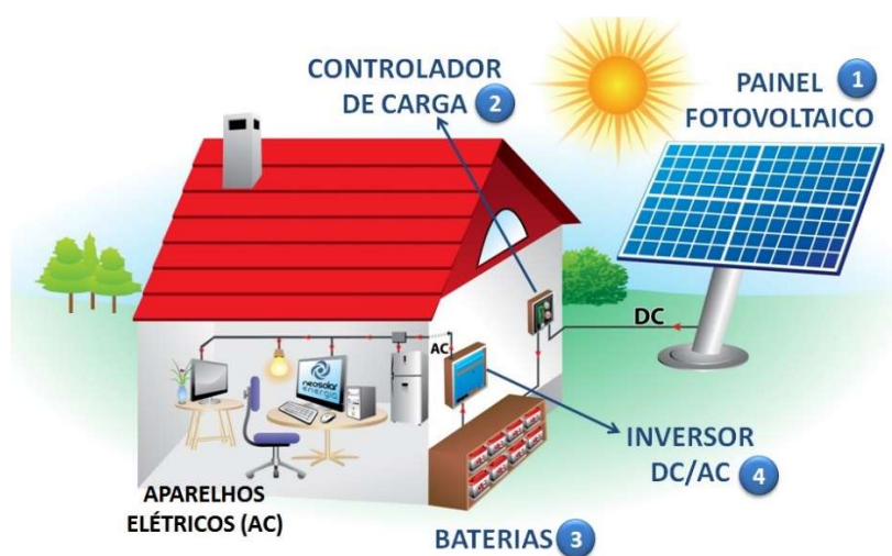
Figura 162-sistema fotovoltaico de autoconsumo
