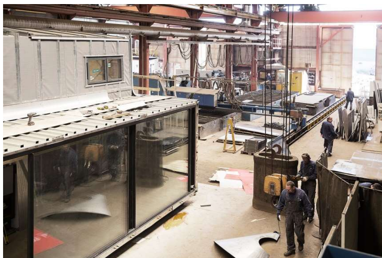
Figura 67-pré fabricação executada em fábrica
