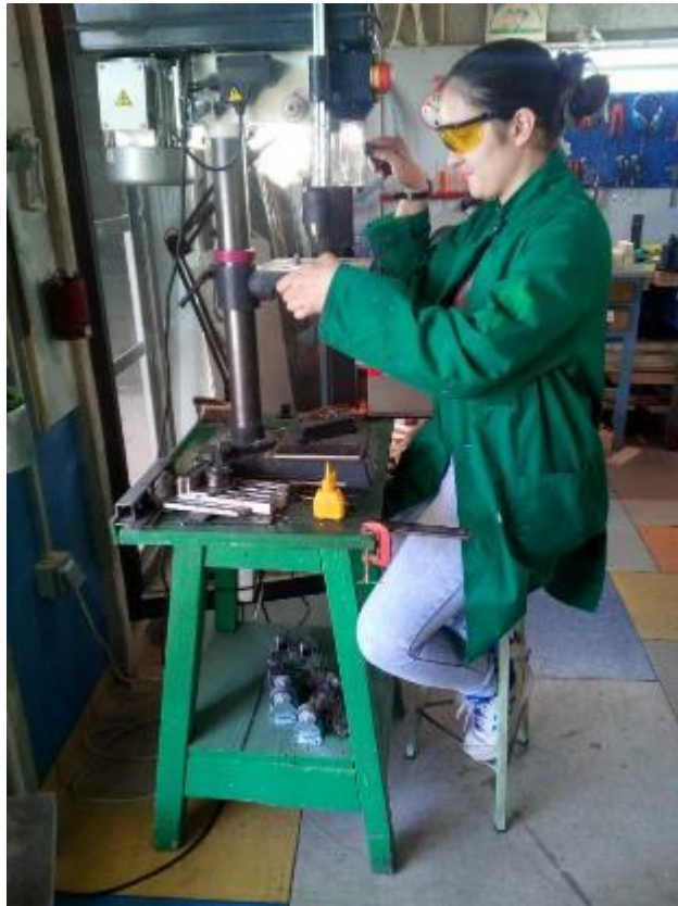
Figura 100 - Furação de barra de ferro (Foto: Daniela Gomes)
