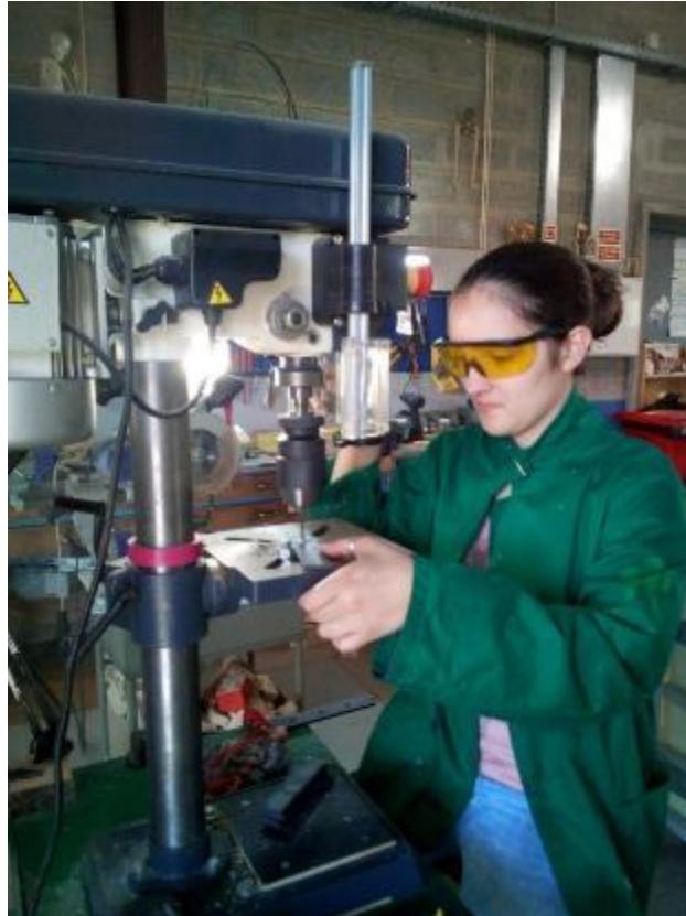
Figura 101 - Furação de barra de ferro 2 (Foto: Daniela Gomes)
