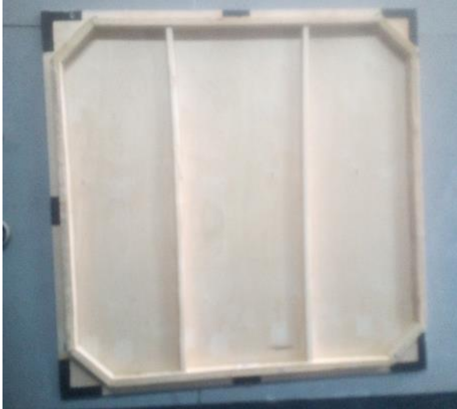
Figura 70 - Madeira estrado com base ripa de telhado (Foto: Daniela Gomes)
