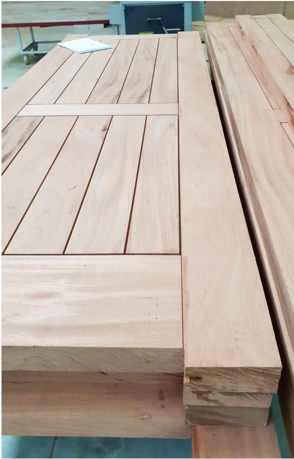
Figura 43: Portas em execução, à direita já com envernizamento
