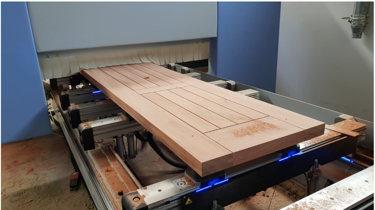
Figura 44: Corte para retirar excessos exteriores em CNC
