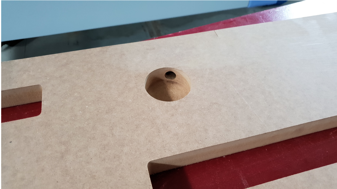
Figura 23: Perfuração para a calha da iluminação
