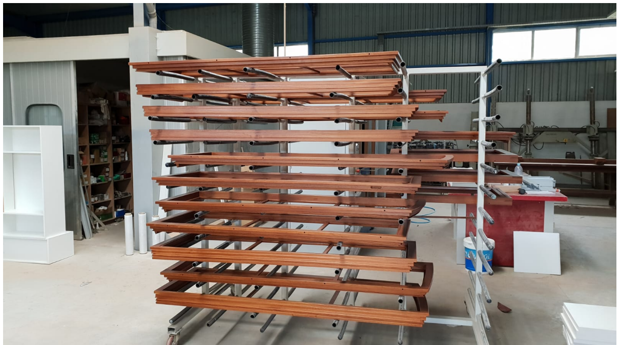
Figura 39: Janelas finalizadas para a colocação de vidro duplo.
