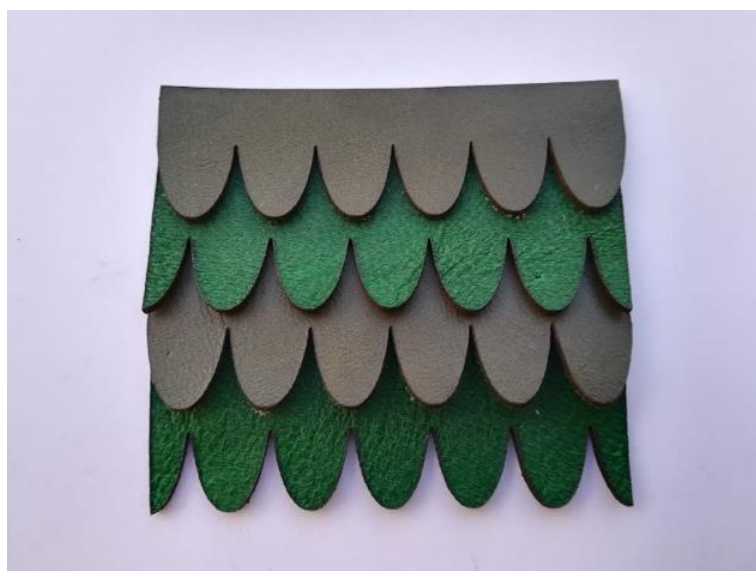
Figura 37 – De cima para baixo: Primeira tentativa de corte a laser das escamas sobre um quadrado de napa. Segunda tentativa de corte a laser das escamas, por fila sobrepondo as cores. Fonte: Joana Cardoso
