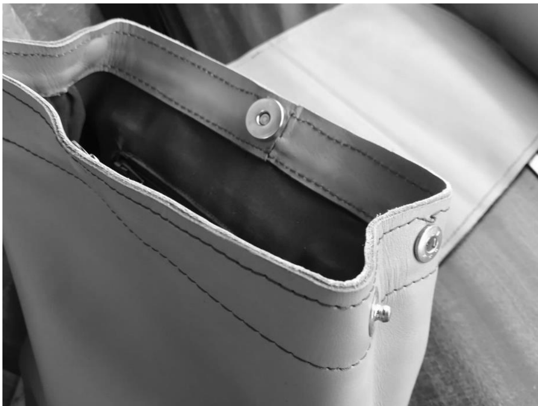
Figura 50 - Resultado da costura do forro e das molas aplicadas. Fonte: Joana Cardoso
