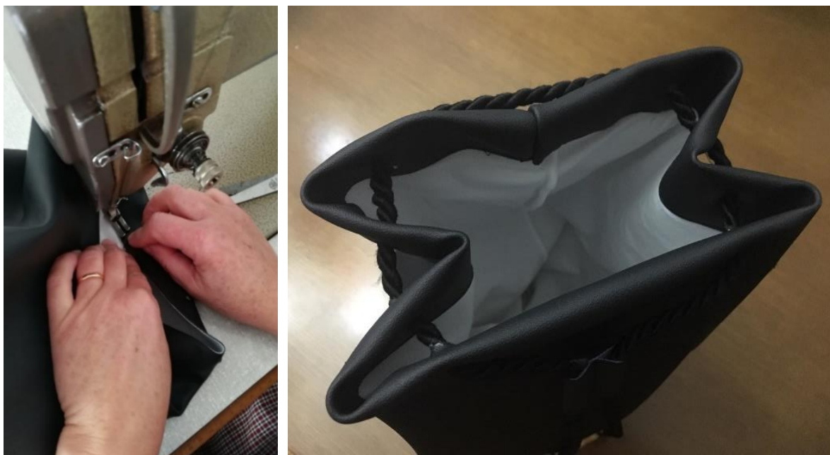
Figura 31 - Da esquerda para a direita: Costura da bainha a ponto corrido. Interior da bolsa. Fonte: Joana Cardoso
