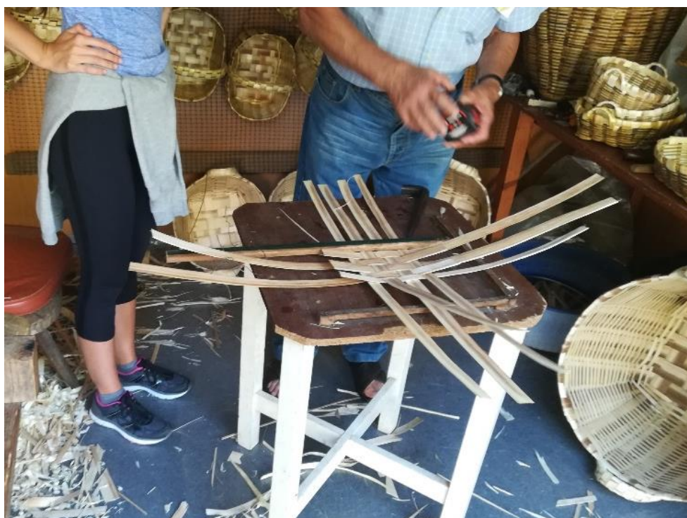
Figura 13 – Processo construtivo do cesto: colocação de tiras compridas alinhadas na vertical e depois na horizontal. Fonte: Joana Pinto
