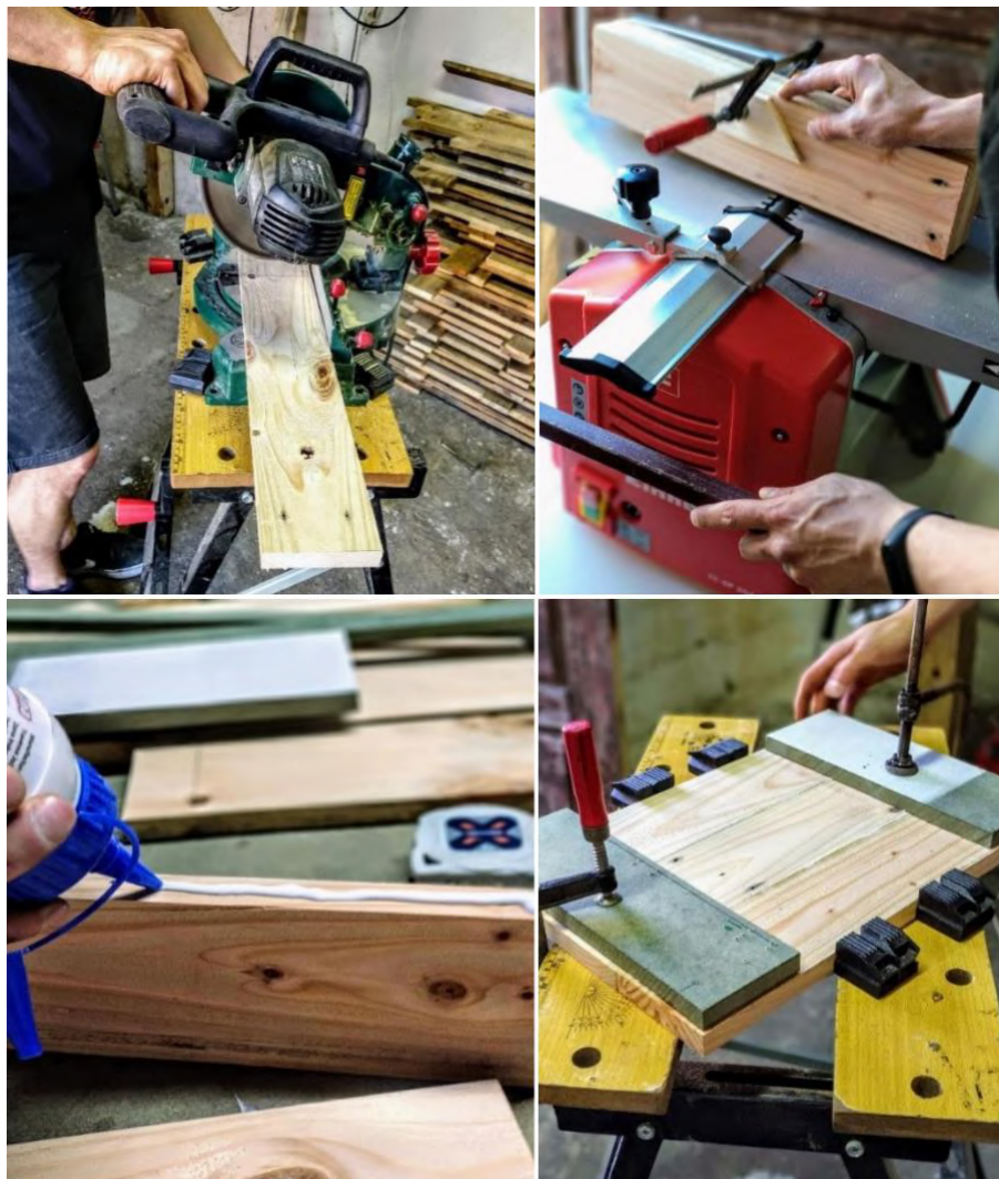
Figura 86 – De cima para baixo e da esquerda para a direita: 1º “Corte das tábuas através de uma serra circular elétrica”. “Momento de polir e laminar as tábuas com uma lixadeira de mesa”. 2º “União das tábuas através de cola branca”. “Molde sobre pressão nas tábuas, formando o tampo”, fotografias de Ana Rita Pinheiro.”
