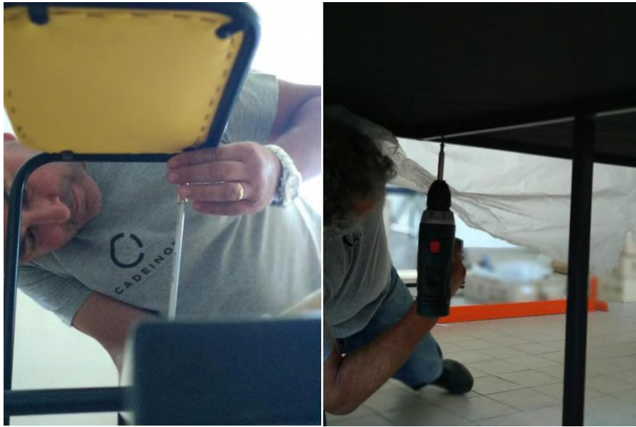
Figura 74 – Da esquerda para a direita: “Auxílio do berbequim e parafusos para a finalização da componente lúdica, fotografia Ana Rita Pinheiro.”. “Junção da estrutura de ferro com o casco e espuma, através de parafusos com o auxílio do berbequim, fotografia de Ana Rita Pinheiro.”.
