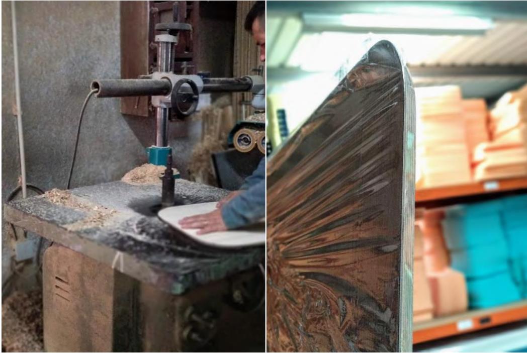
Figura 77 – Da esquerda para a direita: “Utilização da máquina Tupia para a finalidade de chanfrar e bolear os tampos de madeira, fotografia de Ana Rita Pinheiro”. “Efeito de boleado e chanfrado no tampo, fotografia de Ana Rita Pinheiro.”
