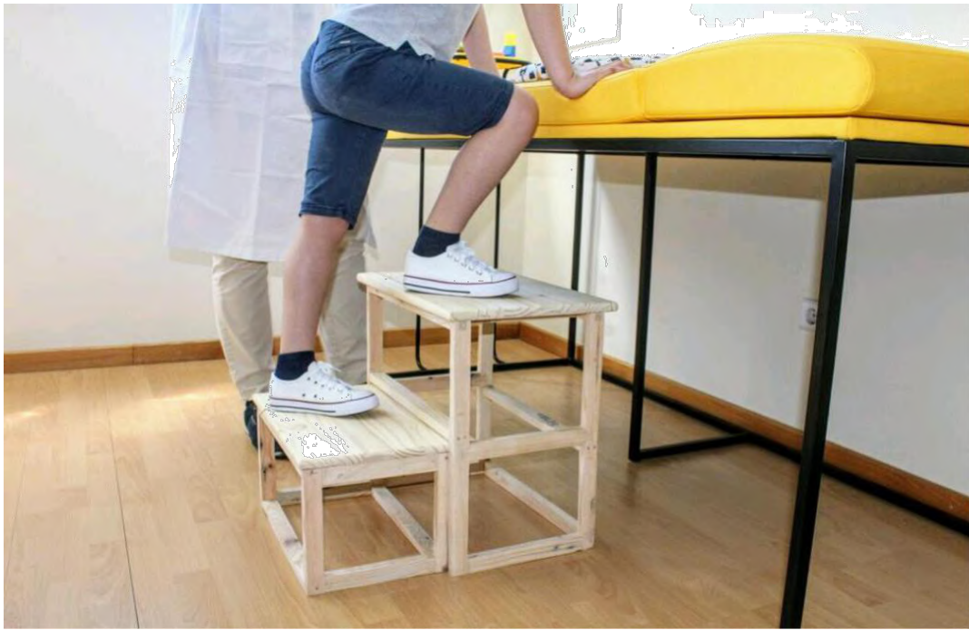
Figura 100 – “Exemplificação da versatilidade do protótipo escadote versátil, a fim, de auxiliar a criança a alcançar a altura da maca, fotografia de Ana Rita Pinheiro.”
