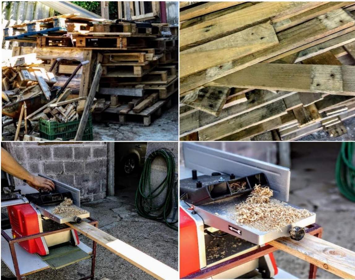
Figura 85 – De cima para baixo e da esquerda para a direita: 1º “Paletes usadas”. “Separação e escolha de tábuas úteis para projetar o escadote versátil”. 2º “Primeiro momento de limpeza através da plaina desengrossadeira”. “Segundo momento de limpeza através da plaina desengrossadeira”, fotografias de Ana Rita Pinheiro.
