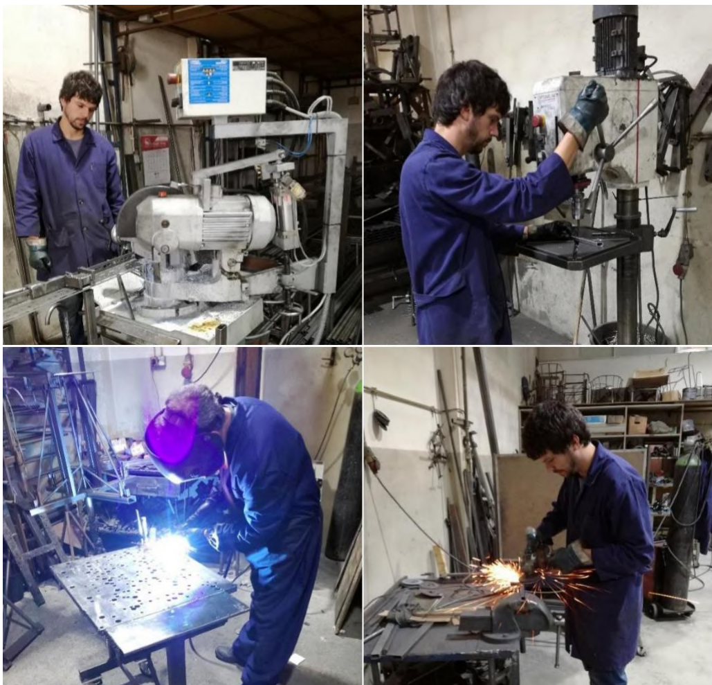
Figura 68 – De cima para baixo e da esquerda para a direita: 1º “Corte do ferro”. “Furação do ferro para inserir parafusos”. 2º “Soldagem de barras de ferro previamente cortadas”. “Rebarbagem da estrutura do ferro”, fotografias de Ana Rita Pinheiro.
