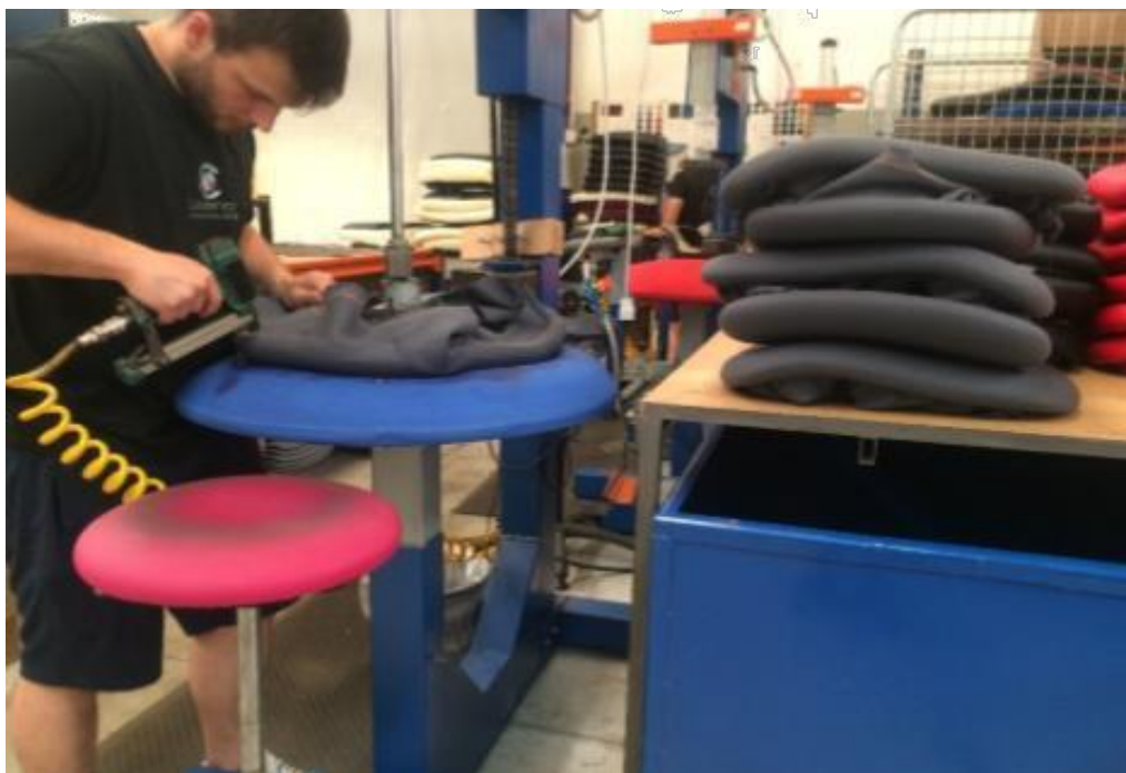
Figura 29 – “Secção da Estofagem através de agrafos, empresa CADEINOR.” Fonte: 67
