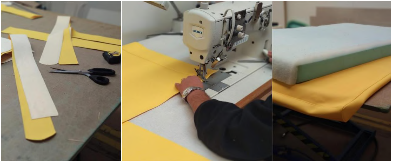
Figura 71 – Da esquerda para a direita: “Corte dos moldes, fotografia de Ana Rita Pinheiro.”. “União dos moldes, através da máquina de costura, fotografia de Ana Rita Pinheiro.”. “Colagem de pasta grossa à volta da espuma, fotografia de Ana Rita Pinheiro.”
