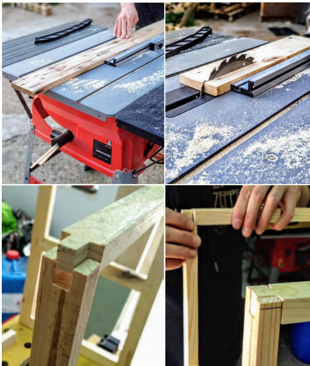
Figura 87 – De cima para baixo e da esquerda para a direita: 1º “Divisão das tábuas”. “Corte das tábuas, respeitando as medidas das pernas”. 2º “União das pernas através de encaixe”. “Teste de encaixe”, fotografias de Ana Rita Pinheiro
