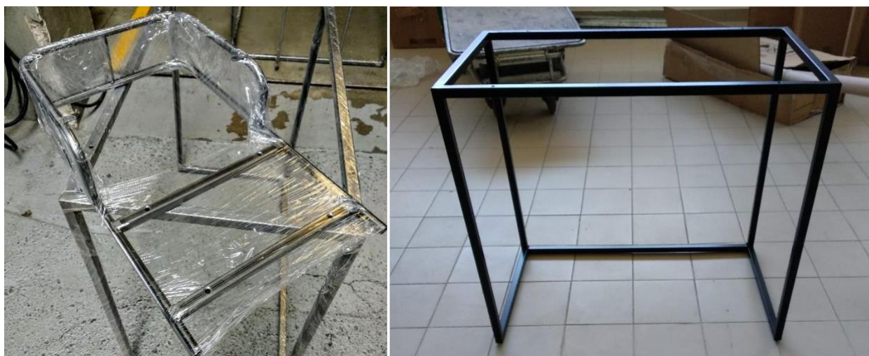
Figura 76 – Da esquerda para a direita: “Estrutura de cubo quadrado para base da secretária juntamente com a estrutura de tubo arredondado da componente lúdica, ainda sem pintura, fotografia de Ana Rita Pinheiro”. “Estrutura da secretária, finalizada com a pintura preto mate, fotografia de Ana Rita Pinheiro.”
