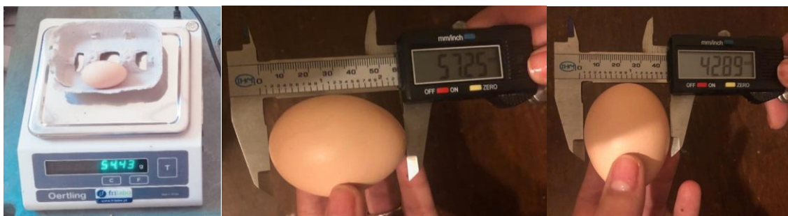
Figura 3.1. Pesagem dos ovos (esquerda) e medição do comprimento e largura do ovo (direita).
