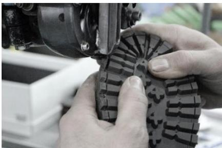
Figura 58 - Máquina de Cozer Solas. Fonte: Marta OLIVEIRA
