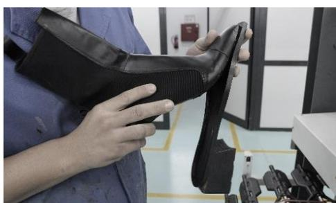
Figura 128 - Junção da Sola à Gáspea manualmente. Fonte: Marta OLIVEIRA
