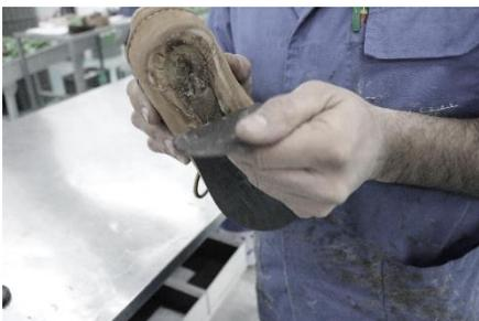
Figura 59 - Colagem da entre sola à gáspea, manualmente. Fonte: Marta OLIVEIRA
