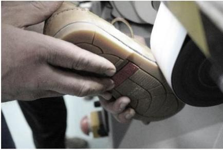
Figura 63 - Máquina de Cardar, lixar o excesso de sola. Fonte: Marta OLIVEIRA
