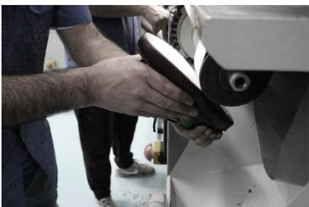
Figura 50 - Máquina de Cardar. Fonte: Marta OLIVEIRA
