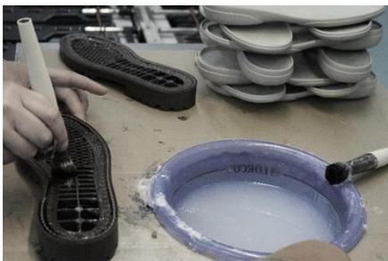
Figura 52 - Aplicação de Cola manualmente à Sola. Fonte: Marta OLIVEIRA
