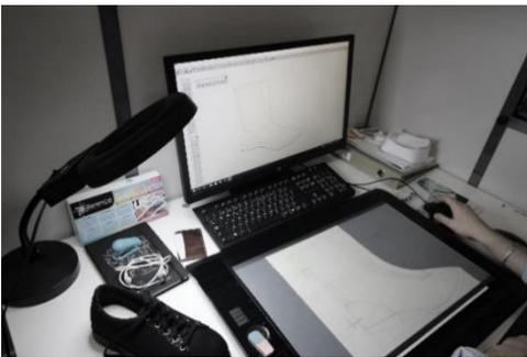
O Cartão é exposto num painel onde se faz o contorno da bota transmitindo o molde para o computador, para assim se poder efetuar o corte.
