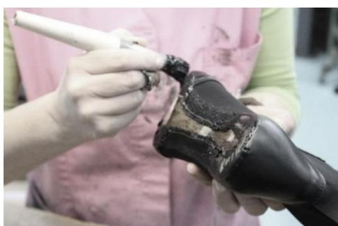
Figura 126 - Solado, aplicação de cola manualmente. Fonte: Marta OLIVEIRA
