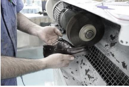
Figura 67 - Máquina Escova Rotativa, retirar o excesso de Massa. Fonte: Marta OLIVEIRA
