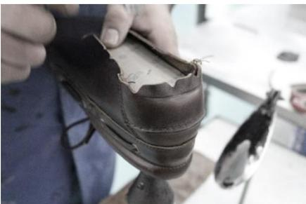
Figura 45 - Aplicação da Forma e da Palmilha de Montagem. Fonte: Marta OLIVEIRA
