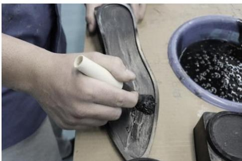
Figura 125 - Solado, aplicação de cola manualmente. Fonte: Marta OLIVEIRA
