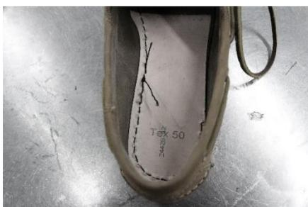
Figura 62 - Aspeto da Costura no interior do sapato, da Máquina de Coser Solas. Fonte: Marta OLIVEIRA
