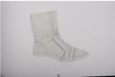
A modelação consistiu na forragem da forma com uma fita de papel, de seguida desenhou-se as linhas com o design desta para de seguida se retirar a fita e colar num cartão.
