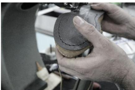
Figura 61 - Máquina de Coser Solas, coser a entre sola à Gáspea. Fonte: Marta OLIVEIRA
