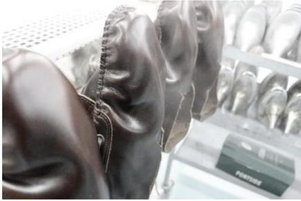
Figura 39 - Máquina Conformadora, amolecer a pele com vapor. Fonte: Marta OLIVEIRA
