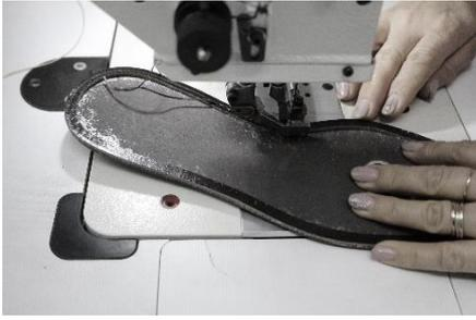
Figura 35 - Cravados na Palmilha de Construção da Entre Sola e na Vira.
