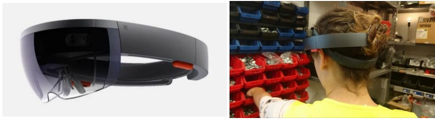
Figura 21 Exemplo de Pick-by-vision (Disponível: igz)
