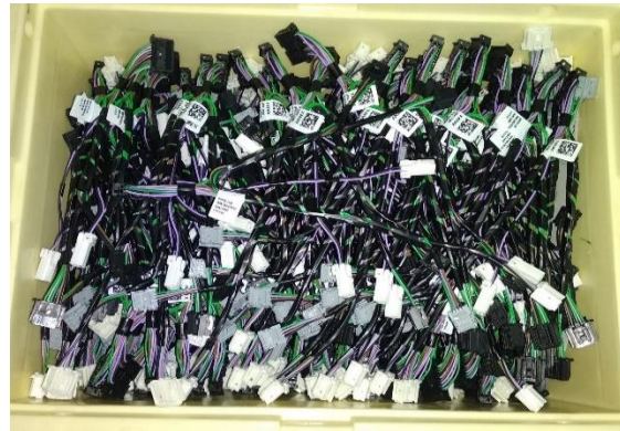
Fios adaptadores de interruptores (Switch adapter wires)
