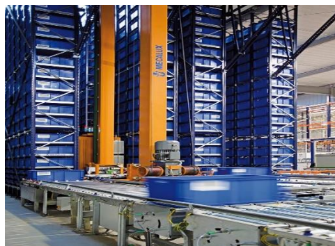
Figura 9 Transelevadores para armazenar caixas (Disponível: Mecalux)
