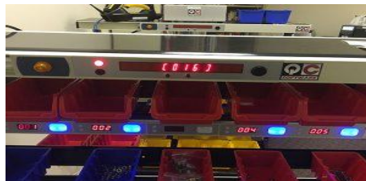
Figura 20 Exemplo de Pick-to-light (Disponível: lightningpick)
