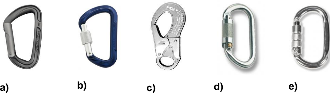
Figura 6 - Mosquetões: a) de pressão, sem bloqueio; b) de rosca, segurança manual; c) de uma mão, segurança automática; d) com segurança de torção automático; e) de segurança em 3 ou 4 vias.
