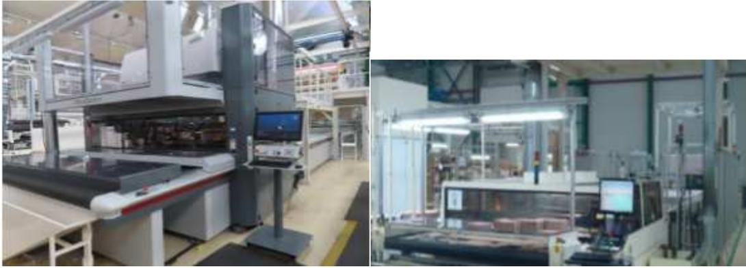
Figura 14 - Máquinas de corte a laser
