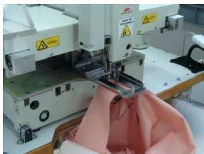
Figura 18 - Máquina de strap, pinças e reforços de interface
