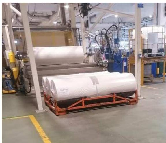
Figura 38 - Exposição dos rolos em frente à máquina de revestimento após implementação do *PP-Kanban*
