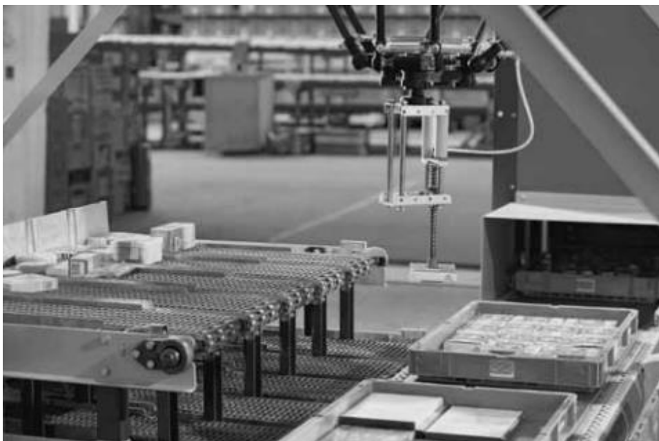
Figura 14 Sistema de picking robotizado fonte: site https://www.mecalux.pt/ , visitado a setembro de 2019
