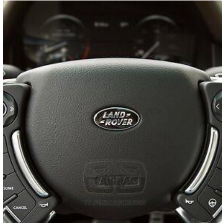
Figura 42 Peça obtida através do processo de serigrafia fonte: site da empresa ( https://www.doureca.pt ), visitado em abril de 2020
