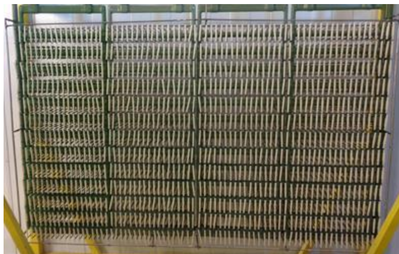
Figura 46 Barra carregada e preparada para ser encaminhada para a linha de cromagem
