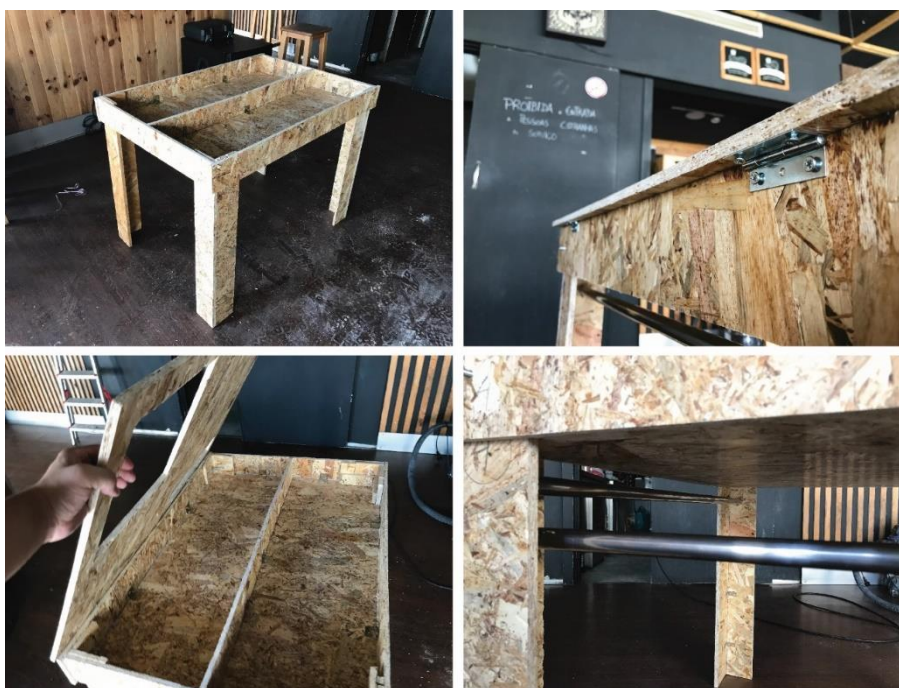
Figura 43 Solução do tampo e estrutura metálica. Foto do autor.
