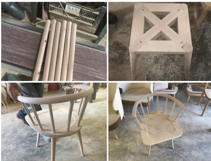
Figura 52 Componentes identificados para a cadeira idealizada. Foto do autor.
