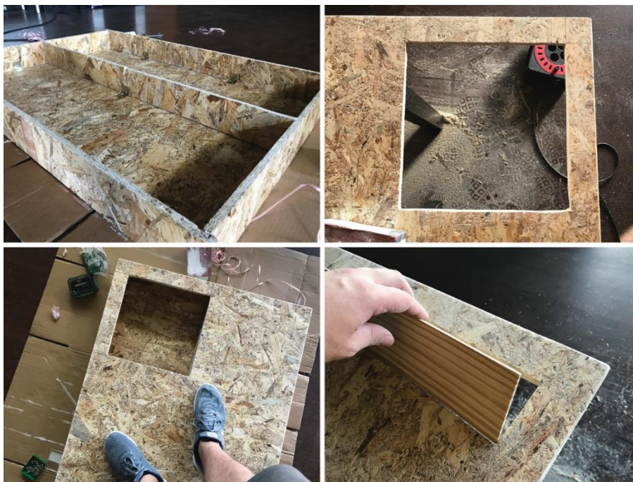
Figura 41 Corte do tampo e teste de resistência do modelo. Foto do autor.
