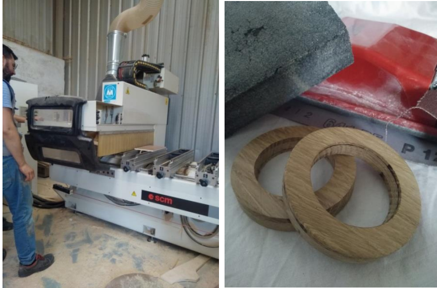
Figura 32 – da esquerda para a direita: CNC na produção das argolas; Lixar manual das argolas. Fontes: Diana CARNEIRO
