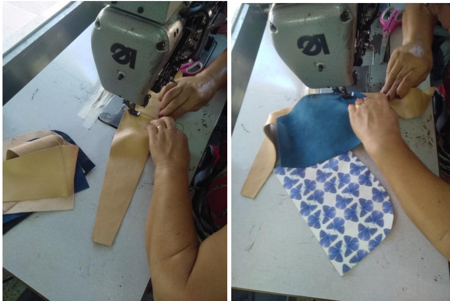
Figura 39 - da esquerda para a direita: união das laterais e fundo; Costura das faces com as laterais e fundo. Fontes: Diana CARNEIRO.
