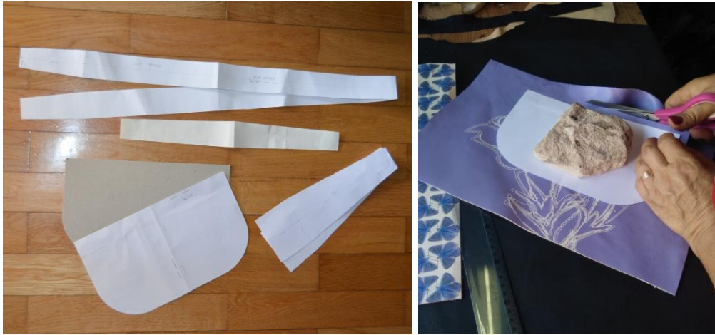
Figura 34 - da esquerda para a direita: Moldes em papel para recortar as peles; Corte das peles através do molde com o auxílio de uma pedra como peso; Fonte: Diana CARNEIRO
