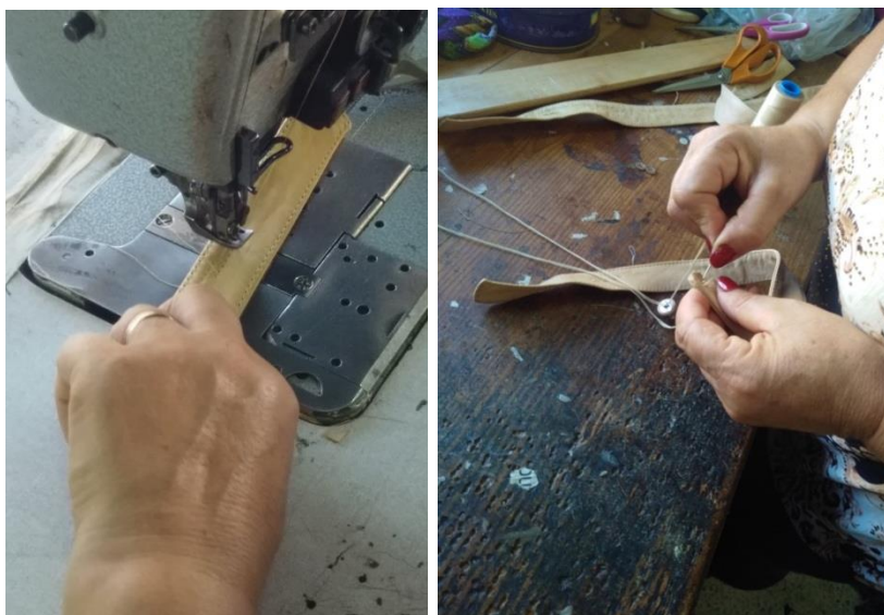
Figura 44 - da esquerda para a direita: costura para a produção de casa do botão; botão costurado à mão; Fonte: Diana CARNEIRO
