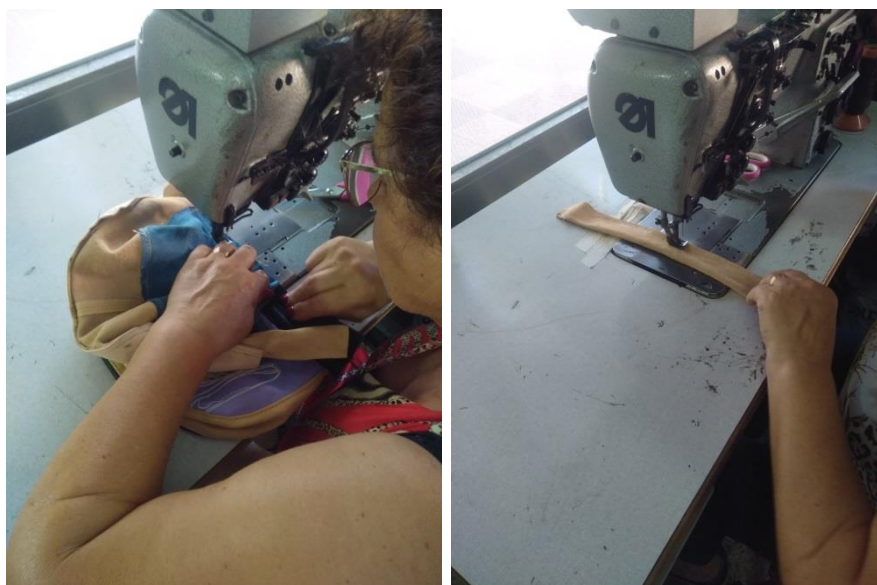
Figura 41 - da esquerda para a direita: pespontar as faces da bolsa; costura das aselhas do lado inverso. Fontes: Diana CARNEIRO
