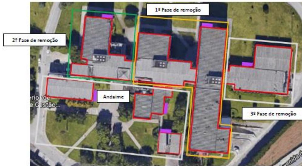
**Figura 17 Fase dos trabalhos de remoção do fibrocimento**
