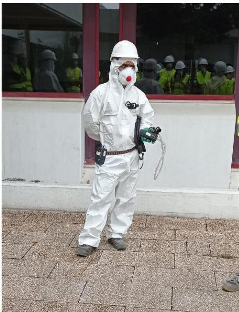
**Figura 16 Trabalhador do amianto com equipamento de recolha de amostras**
