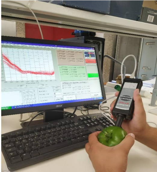
Figura 2.9: Medição do grau de maturação com recurso a um colorímetro
