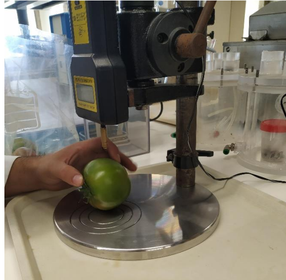
Figura 2.10: Medição da consistência da polpa utilizando um penetrómetro
