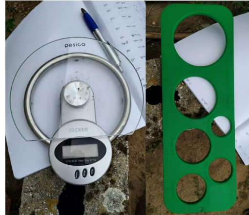
Figura 2.8: À esquerda a balança utilizada para pesar os frutos e à direita, a régua de calibração usada para medir o calibre de cada fruto
