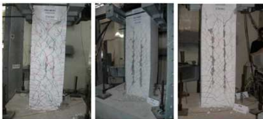
Figura 3.17: Danos observados nos ensaios dos pilares PO1
