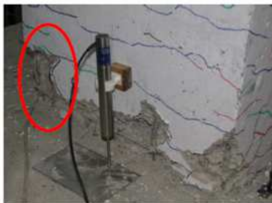
Figura 3.16: Encurvadura dos varões PO1-N2
