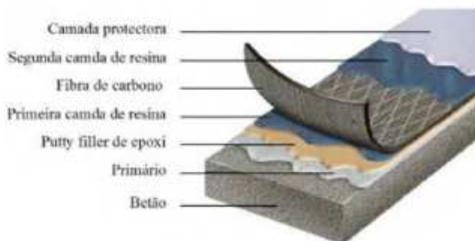
Figura 4.8: Aplicação do sistema FRP (adaptado de BASF, 2007)
