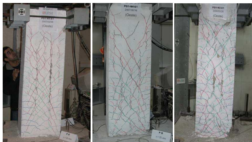
Figura 3.42: Estado limite de dano extenso
