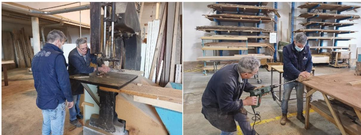
Figura 108- Corte das peças à esquerda e furação à direita (Foto do autor).
