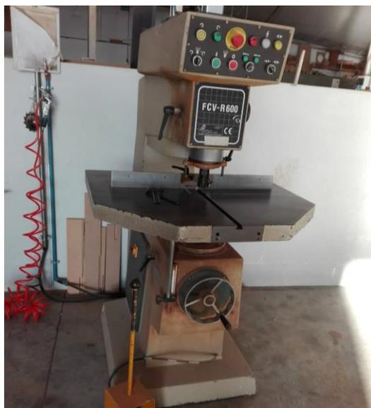
Figura 11- Fresadora copiadora de madeira.
