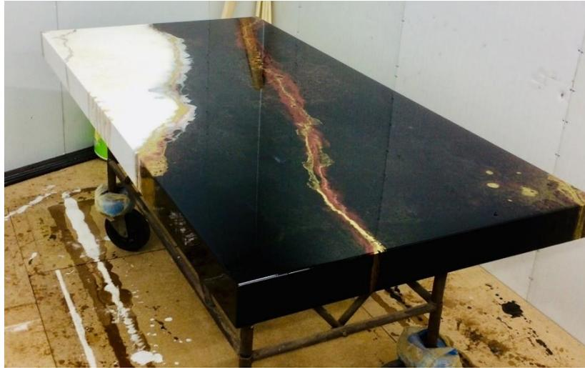
Figura 25- Balcão de cozinha realizado através da técnica de revestimento.
