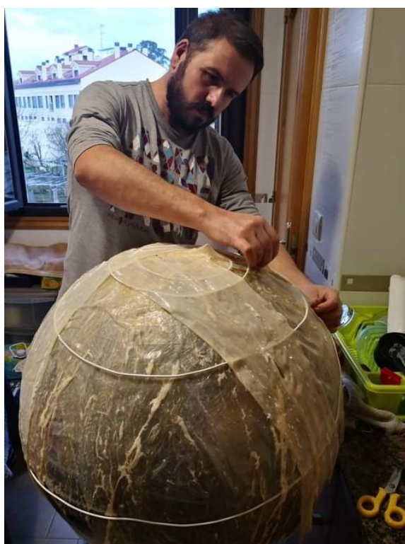
Figura 70- De cima para baixo: Fotografia do autor na primeira fase de colocação do material no molde. Fotografia do autor após 7 dias na fase de colocação da segunda camada de material junto com o arame de alumínio. (Fotografia do autor)
