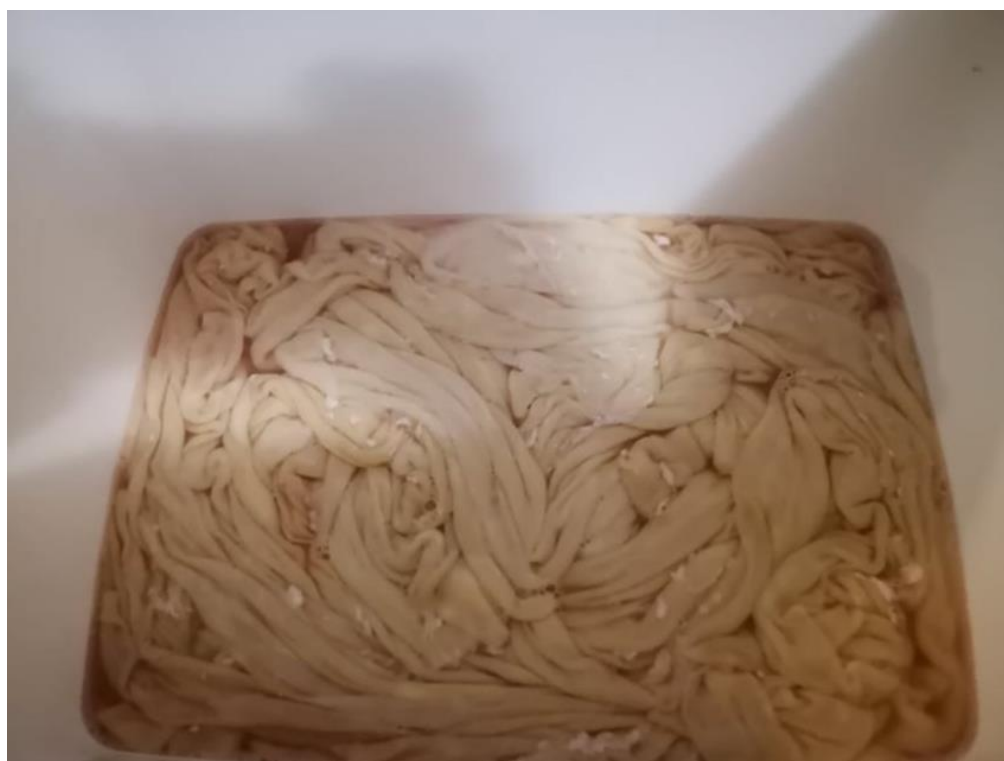
Figura 66- Fotografia do material cortado e em tratamento com solução de Peroxido de hidrogénio H_2O_2 , água oxigenada com (C_6H_5SO_3H) Ácido benzenossulfónico 10%. (Fotografia do autor)
