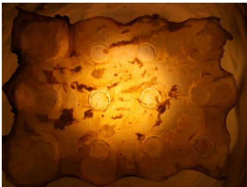
Figura 41- De cima para baixo: Fotografia do resultado do material com formas geométricas submetido a tratamento de solução de Peroxido de hidrogénio H_2O_2 , água oxigenada com (C_6H_5SO_3H) Ácido benzenossulfónico 10%. Fotografia do material resultado do material com formas geométricas submetido a tratamento de solução de Peroxido de hidrogénio H_2O_2 , água oxigenada com (C_6H_5SO_3H) Ácido benzenossulfónico 10% com aplicação de luz (Fotografias do autor)
