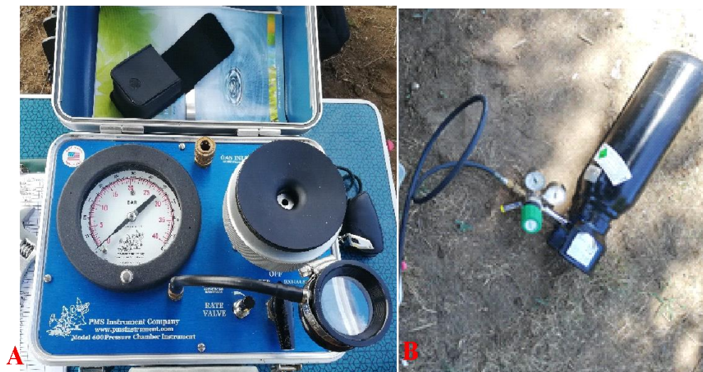
Figura 3.7- Câmera de pressão: A- Câmera de pressão PMS Model 600. B- Botija de Nitrogênio e equipamento necessário.
