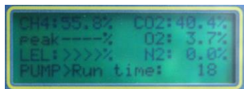
Fotografia 5.3 - Visualização dos parâmetros CH 4 , CO 2 , O 2 e N 2 com bomba em funcionamento desde 18 segundos
