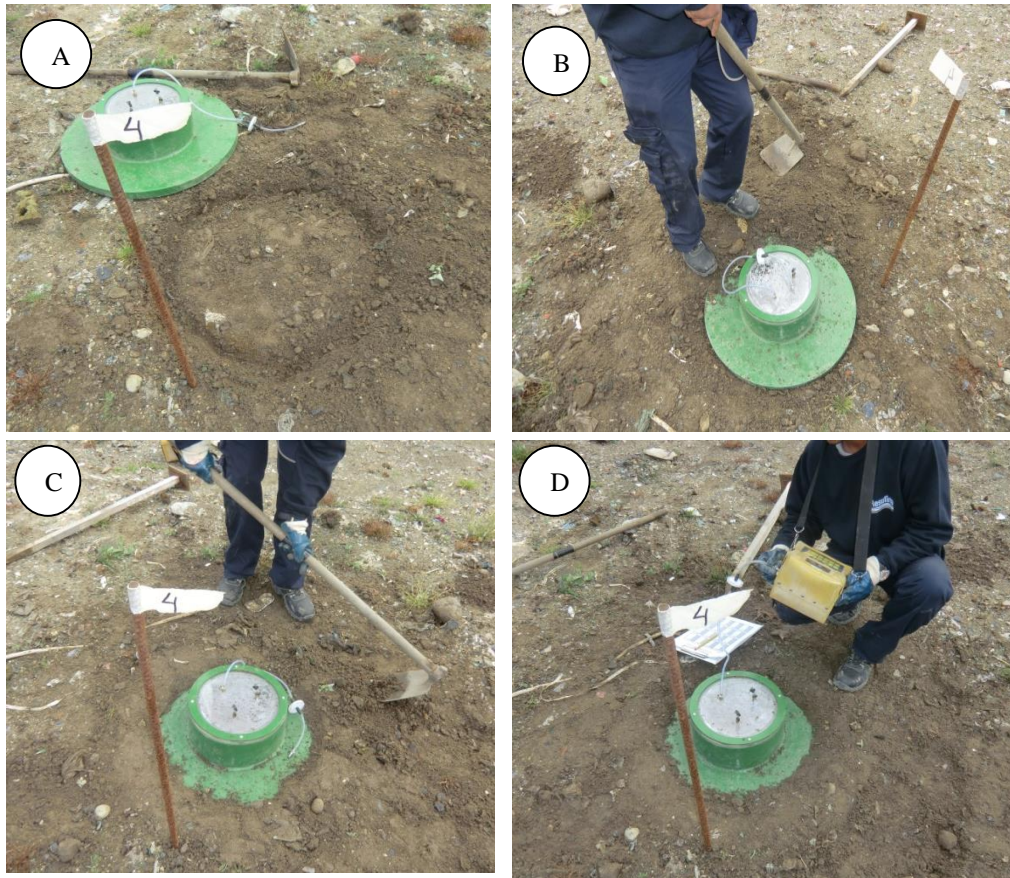
Figura .6.4-Instalação e leitura da concentração dos gases na camada de cobertura do ASVC
