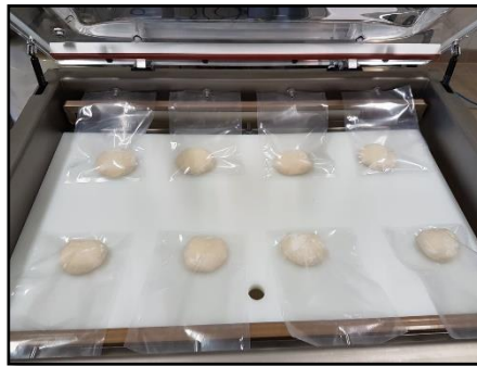
Figura 10 - Aplicação de vácuo parcial nas embalagens de massa de pão.
