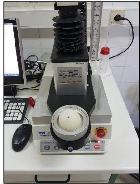
Figura 25 - Exemplo do momento de rutura da massa.
