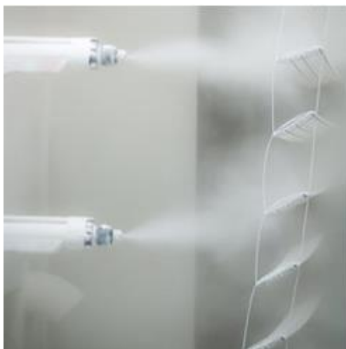
Figura 37_Representação do processo de lacagem
