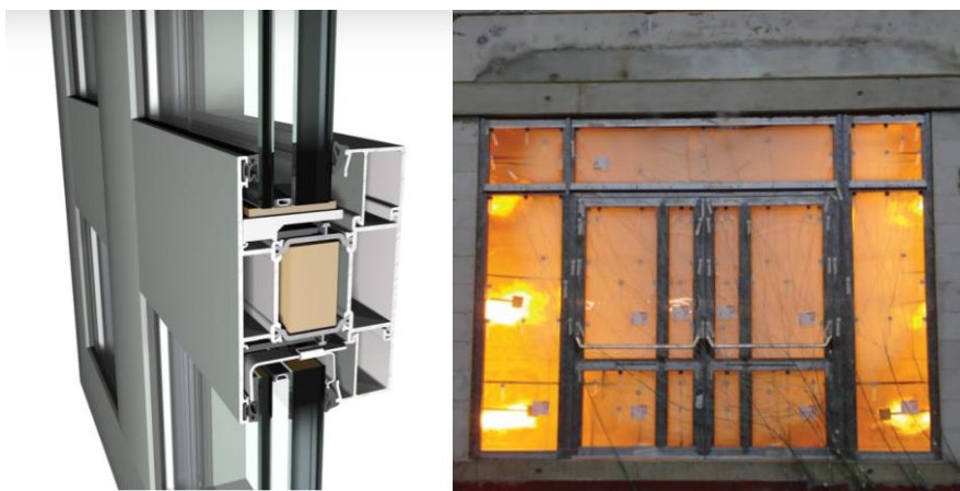
Figura 53_ Corte de sistema de Alumínio à esquerda e à direita teste ao fogo do caixilho composto por 2 folhas de abrir com 5 fixos (Reyners Aluminium, s.d.)
