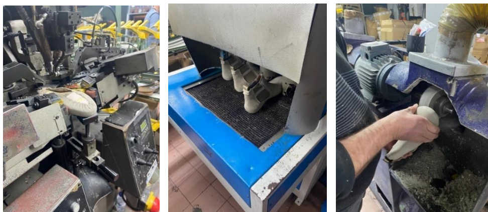
Figuras 111, 112 e 113- Da esquerda para a direita: Fecho do enfranque e calcanheira; Estabilizador a quente; Cardagem. (Fonte: Imagens do autor)
