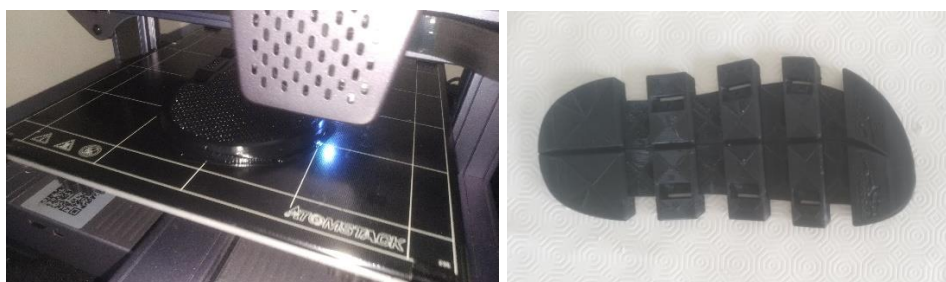
Figuras 169 e 170- Da esquerda para a direita- Impressão 3D em processamento; Componente 1 finalizado. (Fonte: Imagens do autor)
