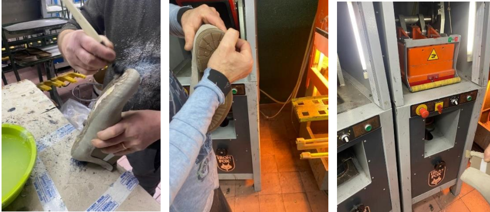
Figuras 114, 115 e 116- Da esquerda para a direita: Colagem da parte superior à sola; Alinhamento da sola à parte superior; Prensagem da sola à forma. (Fonte: Imagens do autor)
