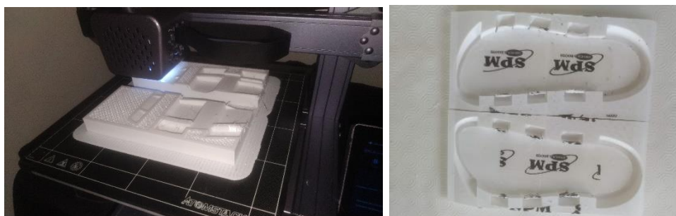
Figuras 175 e 176- Da esquerda para a direita- Molde em processo de impressão 3D; Peças do molde finalizadas e unidas. (Fonte: Imagens do autor)
