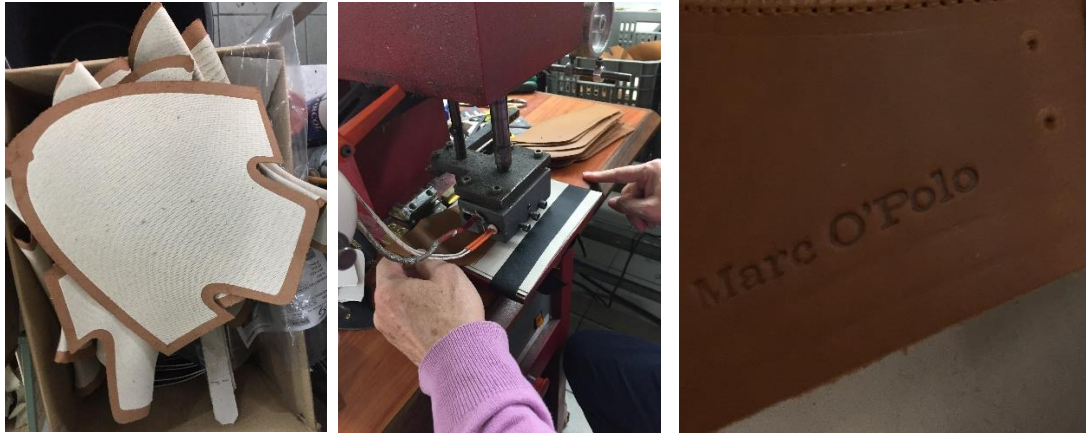
Figuras 98, 99 e 100- Da esquerda para a direita: Gáspea entretelada; Máquina de timbrar; Branding marcado a fogo. (Fonte: Imagens do autor)
