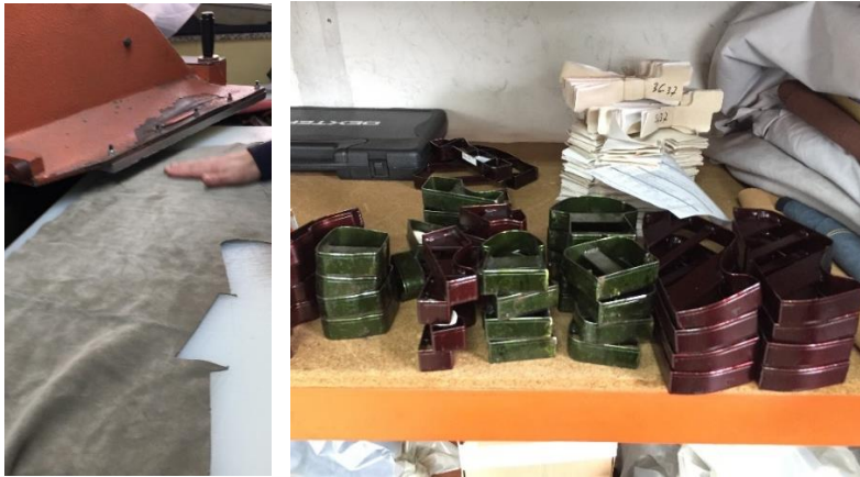
Figuras 94 e 95- Da esquerda para a direita: Corte de couro num balancé de braço; Cortantes. (Fonte: Imagens do autor)
