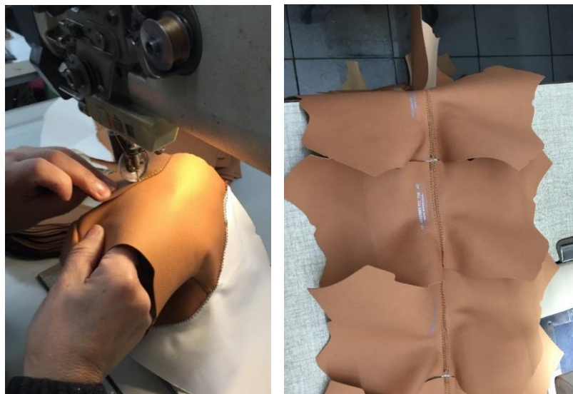
Figuras 101 e 102- Da esquerda para a direita: Calcanheira do forro a ser cosida a uma agulha; Talões do forro unidos em cosido zig-zag. (Fonte: Imagens do autor)
