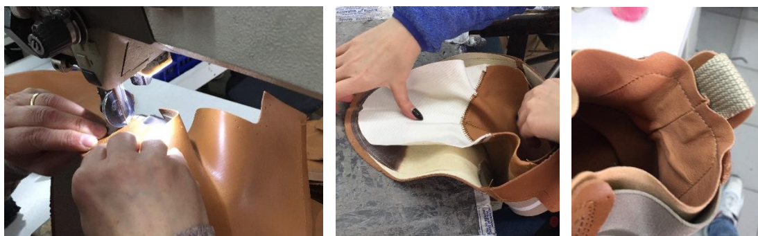
Figuras 103, 104 e 105- Da esquerda para a direita: Costura da parte exterior; Junção do forro à pele através de cola; Costura de união do forro e da pele. (Fonte: Imagens do autor)
