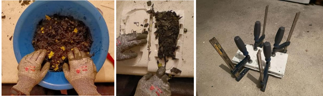
Figuras 181, 182 e 183- Da esquerda para a direita: Mistura dos resíduos com a resina epóxi; Enchimento dos moldes da entressola; Prensagem do molde de enchimento. (Fonte: Imagens do autor)
