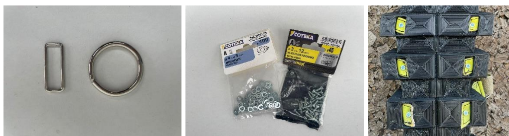
Figuras 199, 200 e 201- Da esquerda para a direita: Ferragens utilizadas na parte superior; Anilhas e parafusos utilizados para fixação; Pormenor da fixação da parte superior à inferior da sandália. (Fotos: Imagens do autor)
