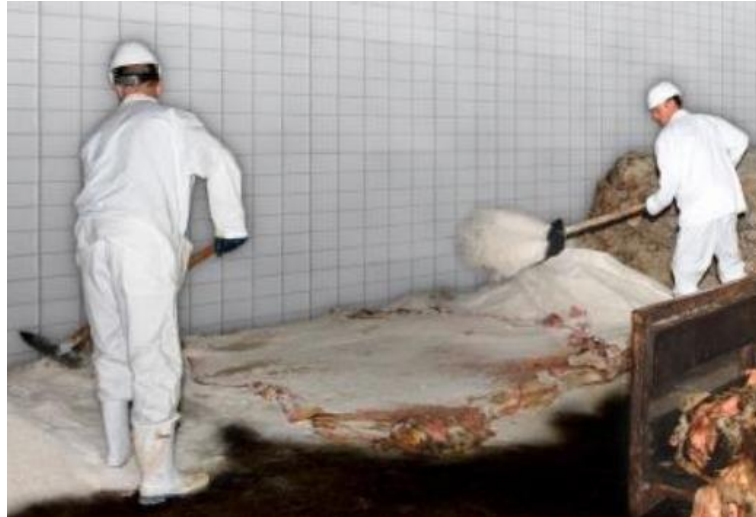
Figura 68- Operação de salga do couro. (Fonte: “Boas práticas para o setor de curtumes”, CTIC, 2015)
