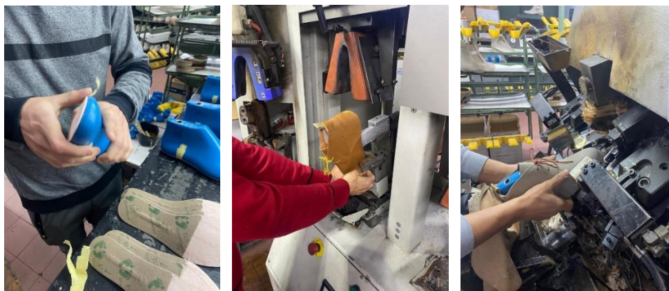
Figuras 108, 109 e 110- Da esquerda para a direita: Fixação da palmilha à forma; Modelagem do contraforte; Montagem da biqueira. (Fonte: Imagens do autor)
