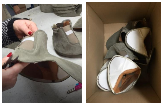
Figuras 106 e 107- Da esquerda para a direita: Parte superior a ser inspecionada; Partes superior prontas para a montagem. (Fonte: Imagens do autor)
