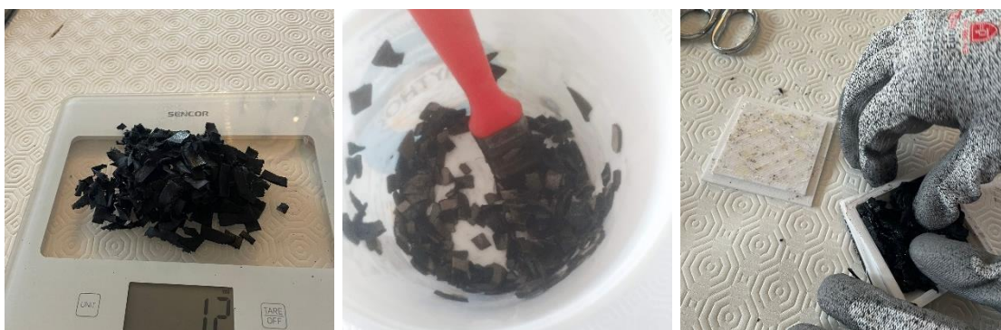
Figuras 138, 139 e 140- Da esquerda para a direita: Mistura dos resíduos com o ligante; Prensagem manual dos resíduos sobre o molde. (Fonte: Imagens do autor)
