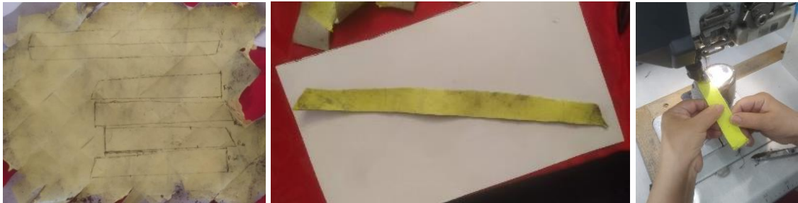
Figuras 193, 194 e 195- Da esquerda para a direita: Marcação das tiras no material; Recorte das tiras; Costura das tiras. (Fonte: Imagens do autor)
