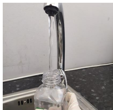
Figura 10. Recolha de água de abastecimento.
