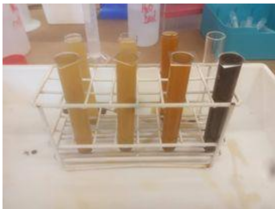
Figura 3.2. – Preenchimento dos tubos de ensaio até formação de um menisco convexo (original).
