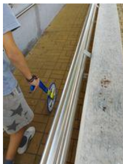
FIGURA 43 - O GRUPO "STONKS" MEDE O COMPRIMENTO DA RAMPA COM O CURVÍMETRO
