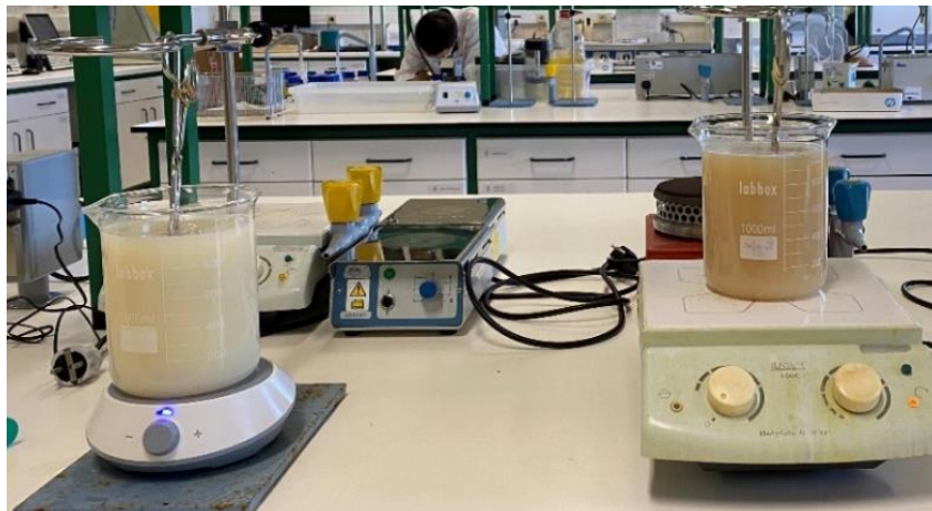
Figura 5: Representação do método de revestimento por imersão suspensa com agitação.
