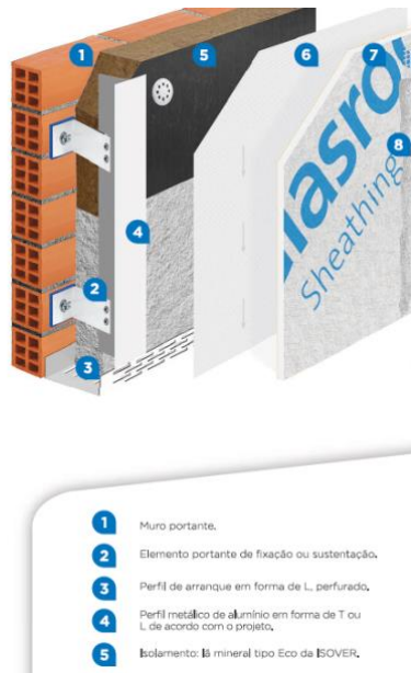
Figura 9 – Composição de uma fachada ventilada [18].
