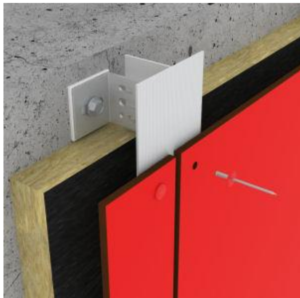
Figura 23 – Detalhe de fachada ventilada com revestimento em placas de aglomerado de madeira [72].
