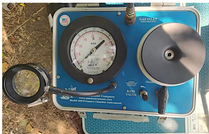
Figura 3.8 —Câmara de pressão (PMS Instrument Compny, Model 600 Pressure Chamber Instrument) utilizada no ensaio.
