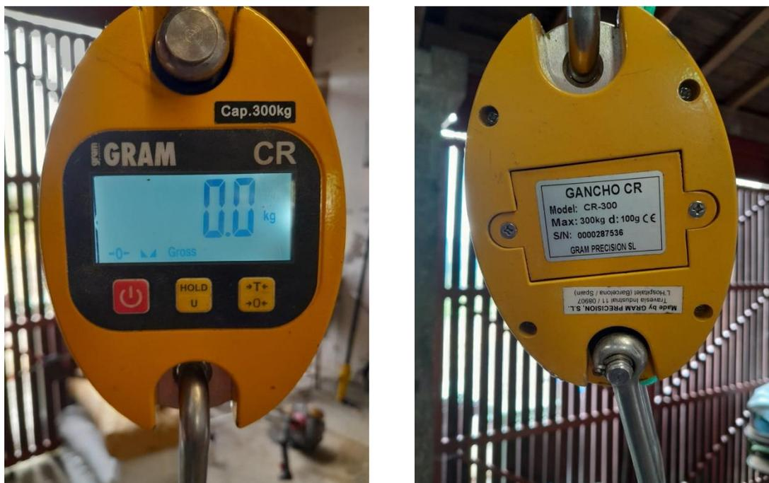
Figura 2.8 - Balança digital com Gram-CR-300.
